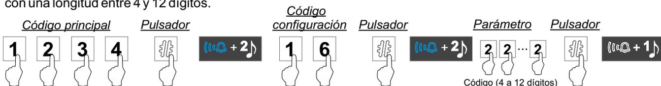
**Función 13. Habilitar códigos de accesos para activar la salida auxiliar:** La siguiente secuencia de programación permite habilitar hasta 20 códigos de acceso distintos para activar la salida auxiliar introduciendo el código de acceso habilitado (con una longitud del código entre 4 y 12 dígitos) mediante el teclado de la placa y confirmando con el pulsador
