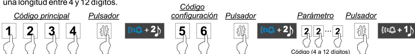
**Función 15. Habilitar códigos de accesos “visita” para activar la salida auxiliar:** La siguiente secuencia de programación permite habilitar hasta 4 códigos de acceso distintos para activar la salida auxiliar introduciendo el código de acceso habilitado (con una longitud del código entre 4 y 12 dígitos) mediante el teclado de la placa y confirmando con el pulsador
