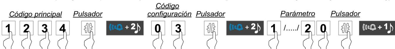
**Función 5. Tiempo activación salida abrepuertas:** La siguiente secuencia de programación permite ajustar el tiempo de activación (3 segundos “por defecto”) de la salida abrepuertas (parámetros: 1:0,5 seg / 2: 1 seg /...../ 20: 10 seg).
