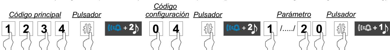
**Función 6. Pulsador exterior “AP” de activación remota:** La siguiente secuencia de programación permite seleccionar que salida activará el pulsador exterior “AP” (parámetros: 0: abrepuertas “por defecto” / 1: relé auxiliar / 2: ambos).
