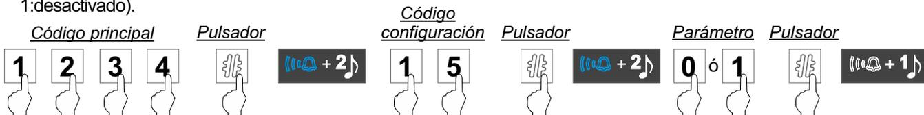
**Función 12. Habilitar códigos de accesos para apertura de la puerta:** La siguiente secuencia de programación permite habilitar hasta 20 códigos de acceso distintos para activar el abrepuertas introduciendo el código de acceso habilitado (con una longitud del código entre 4 y 12 dígitos) mediante el teclado de la placa y confirmando con el pulsador
