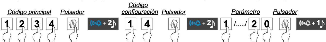
**Función 8. Volumen altavoz placa:** La siguiente secuencia de programación permite ajustar el volumen del altavoz en la placa (3 “por defecto”) de mínimo a máximo (parámetros: de (1 a 5) 1: mínimo /...../ 5: máximo).
