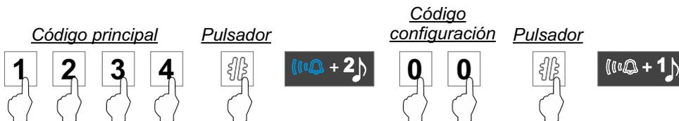
**Función 2, Cambiar código principal:** La siguiente secuencia de programación permite cambiar el código principal (1234 "por defecto") por otro diferente al configurado de fábrica y con una longitud del código entre 4 y 12 dígitos.
