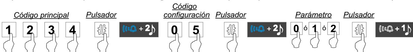
**Función 7. Pulsador exterior “AP” retardo de activación remota:** La siguiente secuencia de programación permite ajustar el tiempo de retardo activación (2 seg. “por defecto”) del pulsador exterior “AP” (parámetros: 1:0,5 seg / 2: 1 seg /...../ 20: 10 seg).
