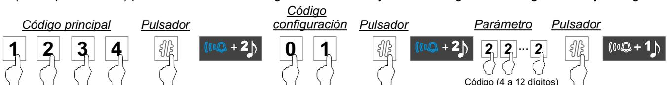
**Función 3, Leds pulsadores teclado iluminados por la noche:** La siguiente secuencia de programación permite que el teclado esté o no iluminado durante la noche (parámetros: 0: Iluminado "por defecto" / 1: apagado).
