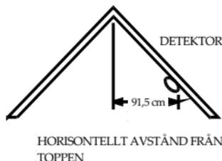
Figur 4: Rekommenderad monteringsplats för rök- och värmedetektorer i rum med lutande tak eller gavlar (lutning > 20 grader).
