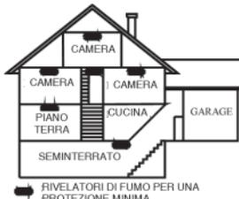
Figura 2: Posizionamento dei rivelatori di fumo e calore in una abitazione su più livelli
