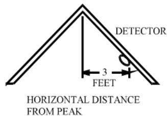
Figuur 4: Aanbevolen locatie om een rook & hitte detector te installeren in ruimtes met hellende plafonds of gevallen. (helling >20 graden).
