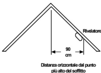
Figura 4: Posizione consigliata di installazione dei rivelatori di fumo e di calore nei locali con soffitti particolarmente inclinati ( $>20^\circ$ ).
