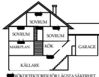
Figur 2: Monteringsplatser för rök- och värmemedetektorer i lägenheter eller hus med flera våningar
