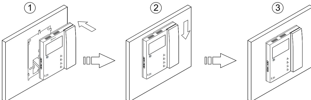
**INSTALLATION DU MONITEUR DANS LE BOÎTIER D'ENCASTREMENT**
