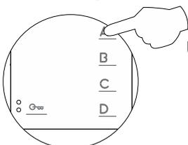
Une fois la programmation avancée terminée, le moniteur reste éteint : Presser le poussoir **A** pendant 1 seconde pour allumer le moniteur, (la LED d'état du moniteur reste allumée en rouge). Après chaque réinitialisation du moniteur et durant les 45 secondes suivantes, aucune opération ne pourra être réalisée.
