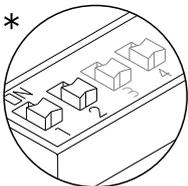
Dip1 et Dip2 : permet de configurer le moniteur comme principal /secondaire + intercommunication. Dip1 et Dip2 sur OFF principal, Dip1 sur OFF et Dip2 sur ON secondaire 1, Dip1 sur ON et Dip2 sur OFF secondaire 2, Dip1 et Dip2 sur ON secondaire 3.
