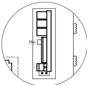
Le connecteur CN4 est situé à l'arrière et à droite du moniteur. Pour insérer le module EL-562S, retirer le pontet qui se trouve sur le connecteur CN4 et JP1 du moniteur.
