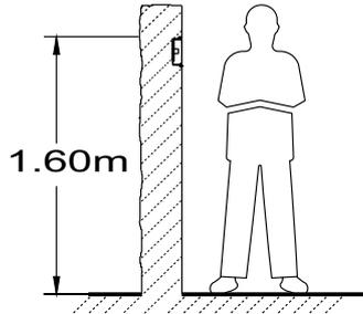
**Installation du boîtier d'encastrement et montage de l'étrier :**
