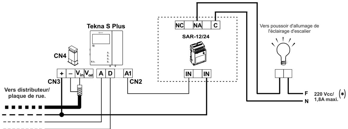
(\*) Le neutre de l'alimentation de l'éclairage est connecté en série au moyen des contacts du relais SAR-12/24, la consommation maximale de l'élément à connecter ne dépassera pas 1,8A.
