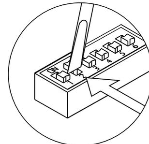
**Important :** Pour procéder à ce mode de programmation, les DIP du micro-interrupteur de programmation rapide SW1 du moniteur doivent être placés sur **OFF**.
