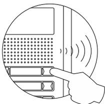
Effectuer un appel pour vérifier que le moniteur est bien programmé. Programmer les autres moniteurs de la même manière. Finaliser la programmation en replaçant le micro-interrupteur de programmation en position OFF. En cas d'oubli, la plaque de rue émettra régulièrement un signal indiquant que le portier se trouve toujours en programmation.
