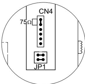
Le pontet de fin de ligne est placé sur le connecteur CN4, situé sur à l'arrière et à droite du moniteur. Dans le cas d'installations avec paire torsadée, le pontet de fin de ligne est placé sur le module EL562S (voir la section suivante). Ne pas retirer le pontet si l'extrémité finale du câble vidéo est connectée au moniteur. Ne retirer le pontet que si le câble vidéo est acheminé au-delà du moniteur.
