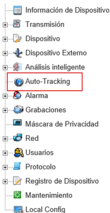
6. Por defecto, el Auto-Tracking está desactivado. Para activarlo, seleccione Auto-Tracking -> ON y pulse en "Aplicar". Además, puede ajustar 3 parámetros.
