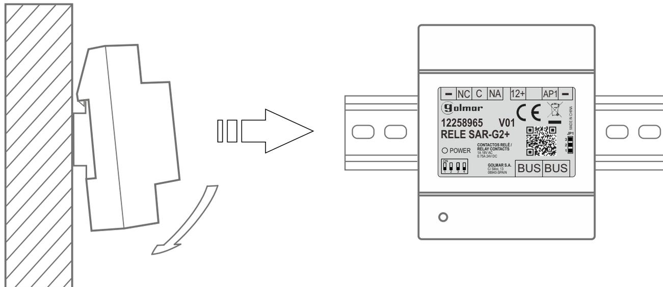
La unidad de relé puede instalarse en guía DIN (4 elementos), realizando una leve presión. Para sacar la unidad de relé de la guía utilizar un destornillador plano y hacer palanca, tal y como muestra el dibujo.
