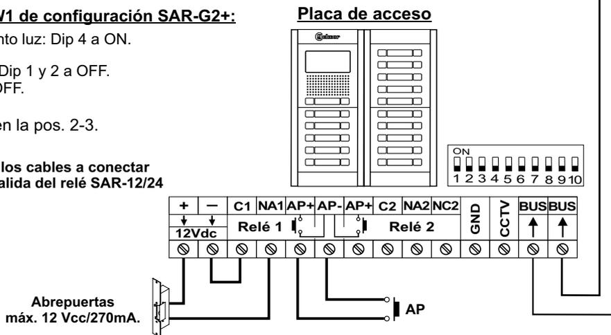
(\*) El neutro de alimentación de la luz escalera va seriada a través de los contactos de relé del SAR-12/24.
