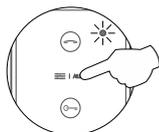
Seleccionar la función que se desee asignar al botón **AUX** : Cada pulsación sobre el botón **AUX** selecciona una función distinta que será indicado con parpadeos (de 1 a 4 parpadeos) en el led de estado y en el siguiente orden (activación de dispositivos auxiliares "A1", llamada a central de conserjería secundaria, autoencendido e intercomunicación) al llegar a la última selección la siguiente pulsación vuelve a la primera selección y 1 parpadeo en el led de estado (modo carrusel).
