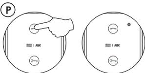
Para programar el terminal como *Principal*, pulse el botón durante 1 segundo, (el led de estado del terminal se ilumina fijo en color rojo y el led de se apagará).
