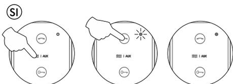
Para programar el terminal como **Secundario + Intercom.**, pulse el botón , el led parpadeará (en color verde) una vez. A continuación pulse el botón durante 1 segundo (el led de estado del terminal se ilumina fijo en color rojo y el led de se apagará).
