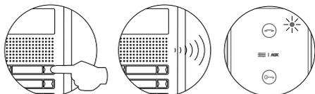
Presionar el pulsador de la placa que se desea que llame a este terminal. En dicho instante, la placa y el auricular del terminal emitirán unos tonos (el led de estado del terminal parpadeará en color rojo y el led de se iluminará fijo).
