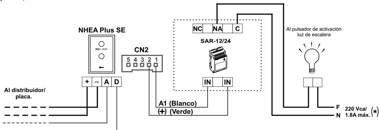
(\*) El neutro de la alimentación de la iluminación va seriado a través de los contactos del relé SAR-12/24, el consumo máximo del elemento a conectar no será superior a 1.8A.
