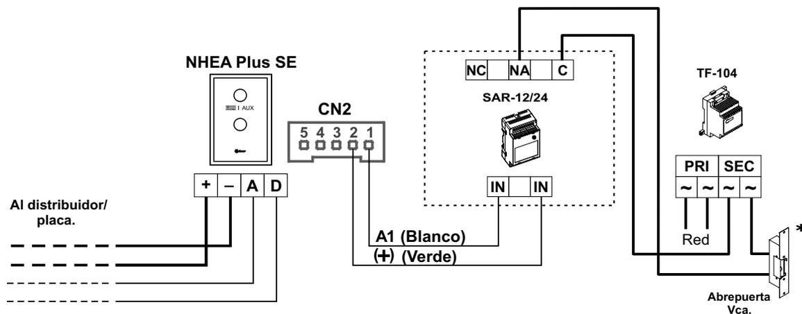
\* **Importante:** Coloque el varistor suministrado con el módulo de sonido directamente sobre los terminales del abrepuertas.
