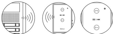
Para indicar que el equipo está listo para la programación, la placa y el terminal emitirán unos tonos (el led de estado del terminal se ilumina fijo en color rojo), pudiendo soltar el pulsador de abrepuertas. El terminal está en comunicación de audio con la placa.
