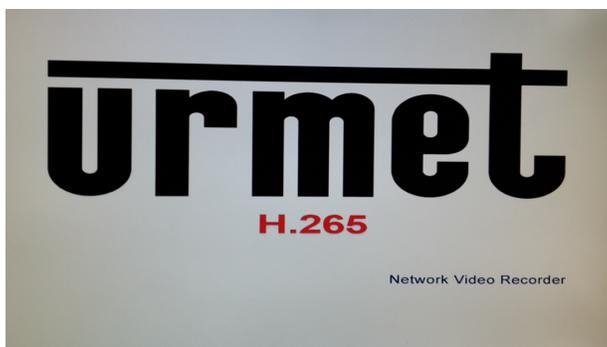
Después de conectar el cable de alimentación del NVR en la toma de pared y de pulsar el botón Power (Alimentación) del panel trasero, se accede a la pantalla de inicialización del sistema, ilustrada más arriba.
