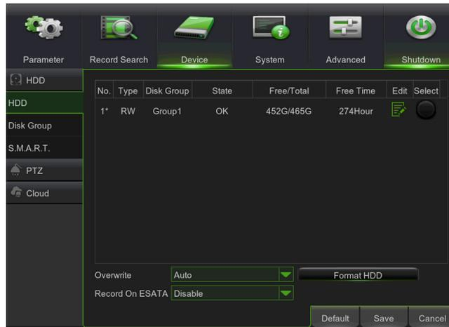
Cuando el DVR está conectado a un HDD, el sistema detecta automáticamente si el estado del HDD es normal o no. Si el cable conectado al HDD está flojo, o si el estado del HDD es anormal, su estado será “No Disk” (Ningún disco duro); si el HDD se debe formatear, su estado será “no format” (sin formato), de lo contrario será “Normal”.
