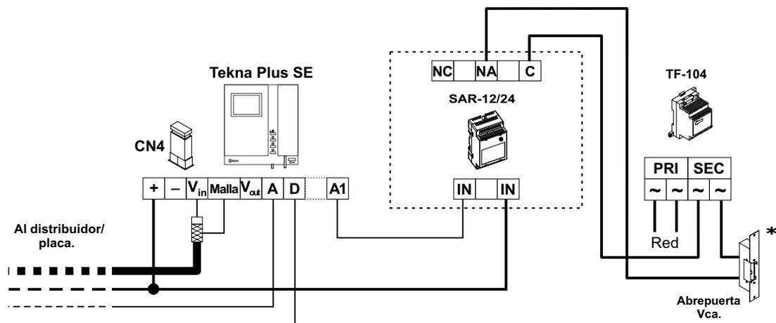
\* **Importante:** Coloque el varistor suministrado con el módulo de sonido directamente sobre los terminales del abrepuertas.
