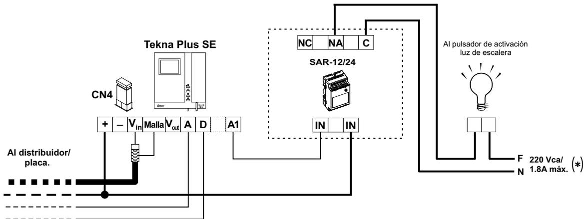
(\*) El neutro de la alimentación de la iluminación va seriado a través de los contactos del relé SAR-12/24, el consumo máximo del elemento a conectar no será superior a 1.8A.
