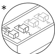
Dip1 y Dip2: Configura el monitor como principal / secundario. Dip1 y Dip2 a OFF principal, Dip1 a ON y Dip2 a OFF secundario 1, Dip1 a OFF y Dip2 a ON secundario 2, Dip1 y Dip2 a ON secundario 3.
