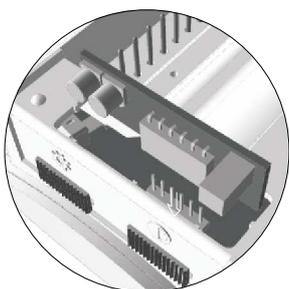
Localizar el conector CN4 de la parte posterior del monitor. Para insertar el módulo EL562, retirar el puente que hay en el conector.
