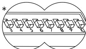
Dip3 a Dip10: Para configurar la dirección del monitor (dirección 1 a 255). Los interruptores colocados en la posición OFF tienen valor cero. En la posición ON tienen asignados los valores de la tabla adjunta. El código del monitor será igual a la suma de valores de los interruptores colocados en ON.
