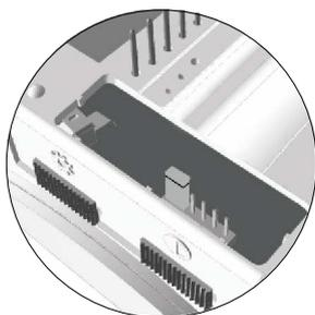
El puente de final de línea se encuentra ubicado en el conector CN4, situado en la parte posterior del monitor. En el caso de instalaciones con par trenzado, el puente de final de línea se encuentra en el módulo EL562 (ver apartado siguiente). No quitar el puente si el cable de video finaliza en el monitor. Quitar el puente si el cable de vídeo continúa después de el monitor.
