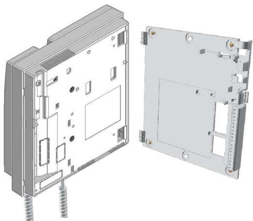
Colocar el monitor perpendicular a la regleta, haciendo coincidir los agujeros de la base del monitor con las pestañas de sujeción de la regleta, tal y como muestra el dibujo.
