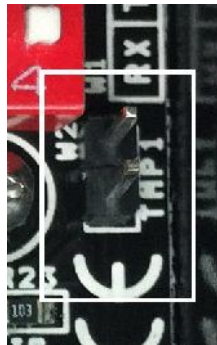
Entrada Tamper adicional, si no se utiliza deberá permanecer cerrado con el puente.
