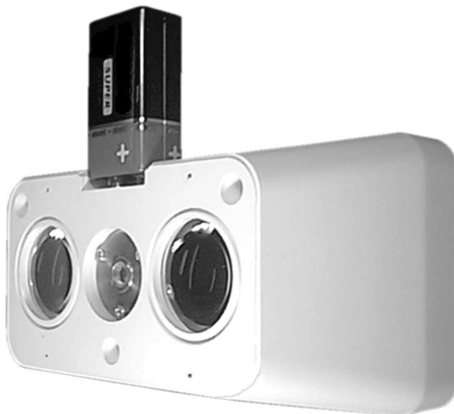
Fig. 2 Detector DETLIN50M-100M durante el ajuste óptico del haz
