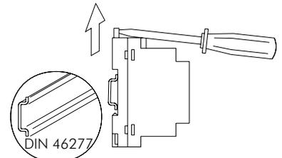
El alimentador puede instalarse en guía DIN (3 elementos), realizando una leve presión. Para sacar el transformador de la guía utilizar un destornillador plano y hacer palanca, tal y como muestra el dibujo.
