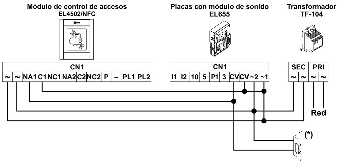
(\*) Los abrepuertas conectados a los equipos de portero electrónico con instalación 4+'n' funcionan a 12V corriente alterna:
