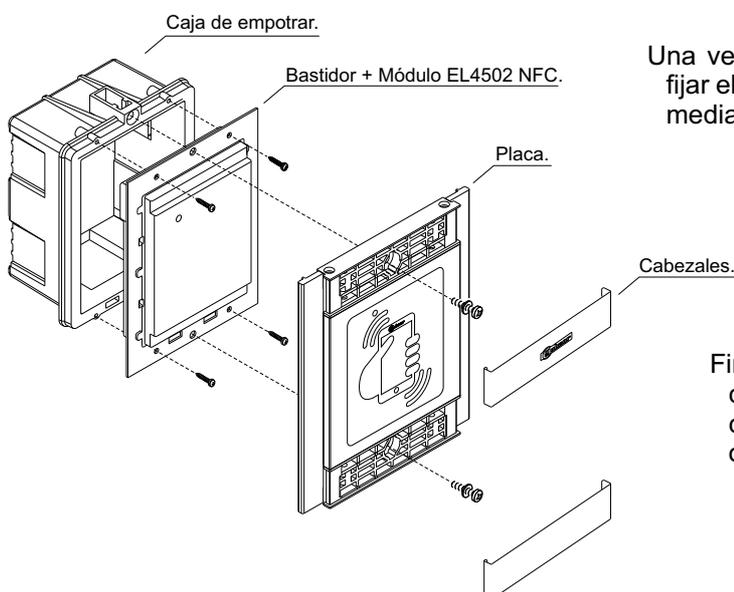
Una vez terminados los trabajos de cableado, fijar el bastidor y la placa a la caja de empotrar mediante los tornillos suministrados.
