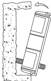
Pasar la instalación por el hueco realizado en la caja de empotrar. Empotrar, enrasar y nivelar la caja. Una vez colocada extraer los adhesivos antiyeso de los orificios de fijación.
