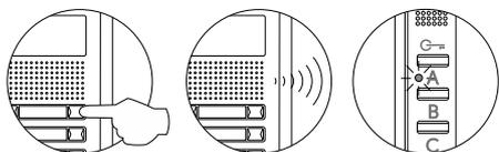
Presionar el pulsador de la placa que se desea que llame a este teléfono. En dicho instante, la placa y el auricular del teléfono emitirán unos tonos (el led del teléfono parpadeará en color rojo).
