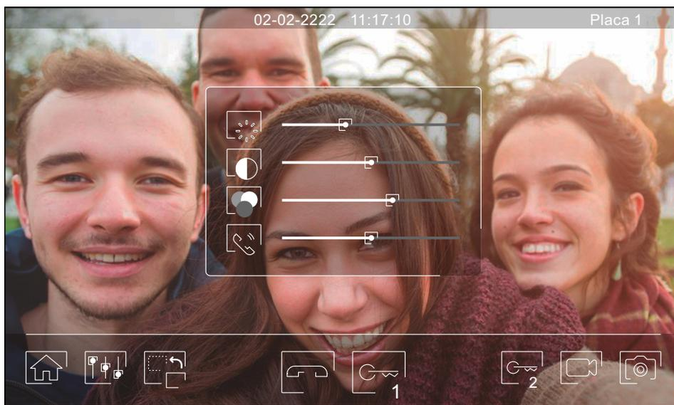
Durante el proceso de visualización o comunicación, es posible ajustar los parámetros de la imagen (brillo, contraste y color), el volumen del timbre de llamada (durante la visualización) y el nivel de audio del altavoz (durante la comunicación).
