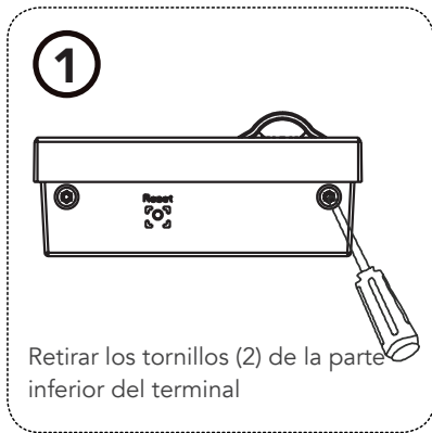
Extraer la parte trasera del terminal
