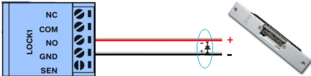
Se puede trabajar con el relé de la salida de abrepuertas como contactos **secos** (sin tensión) y de esta forma adaptar abrepuertas alimentados externamente, incluso con corriente alterna (AC).
