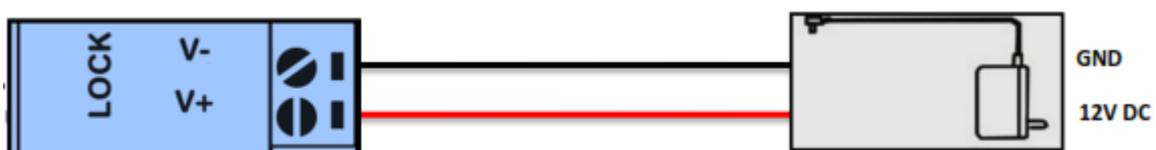
Los abrepuertas irán conectados en cada una de las salidas (**Lock 1; Lock 2, etc**) entre los bornes (**NO +** y **GND -**).
