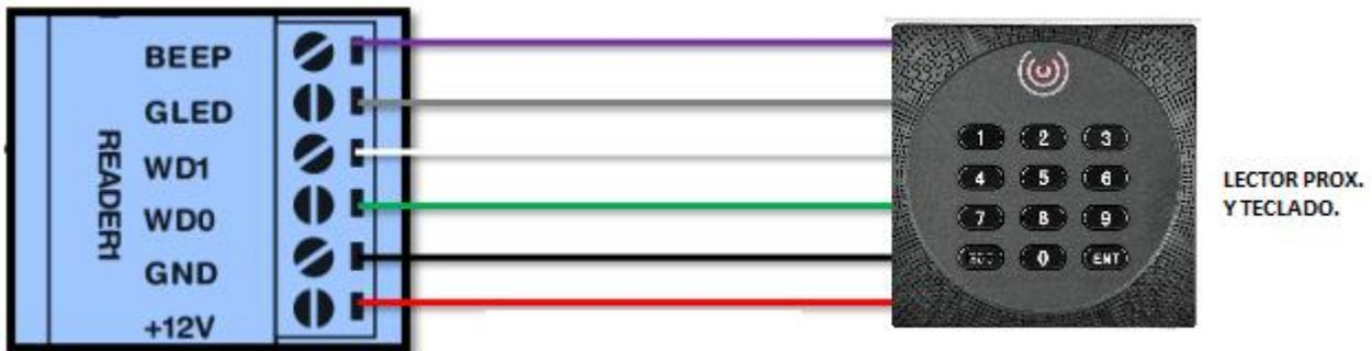
Si la controladora es del modelo GM-INBIO y se colocan lectores de huella, estos han de ir conectados en la entrada del BUS-485:
