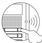
Effectuer un appel pour vérifier que le poste d'appel est bien programmé. Programmer les autres postes d'appel de la même manière. Finaliser la programmation en replaçant le micro-interrupteur de programmation en position OFF. En cas d'oubli la plaque émettra régulièrement un signal indiquant que le portier se trouve toujours en programmation.
