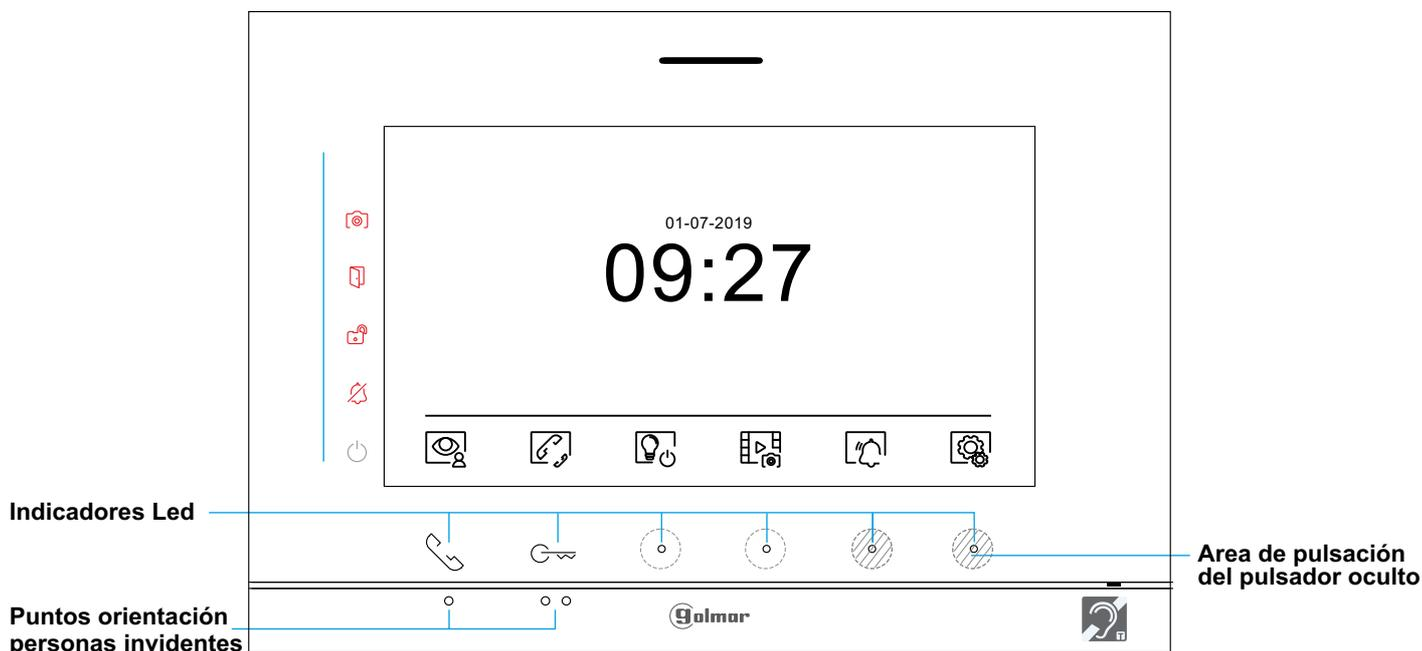
Si el equipo se encuentra en reposo (pantalla apagada), para acceder al menú principal presione en cualquiera de los 2 pulsadores / (situados arriba de los puntos de orientación / para personas invidentes) del monitor. A continuación presione sobre el pulsador/ pulsador oculto situado justo debajo del icono correspondiente. El equipo volverá al estado de reposo transcurrido 20 segundos sin actividad.
