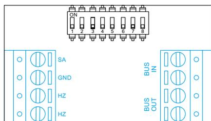
BUS IN: Bus de comunicación entrada monitor (no polarizado).
