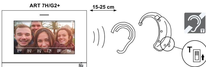
Sitúe el audífono a una distancia entre 15 - 25 cm del monitor para obtener la máxima calidad de audio durante la comunicación con la placa.
