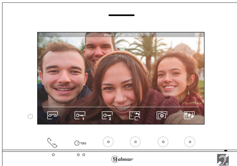
Esta pantalla se muestra durante un proceso de comunicación. En la parte superior central de la pantalla se muestra la fecha y la hora, y a la derecha se muestra la fuente de origen de la imagen (placa 1 a placa 4, cámara 1 a cámara 4).
