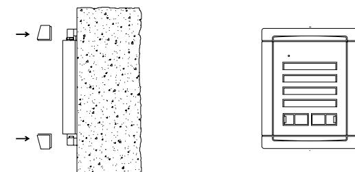
Incorporar y fijar la placa. Ensamblar los cabezales embellecedores.
