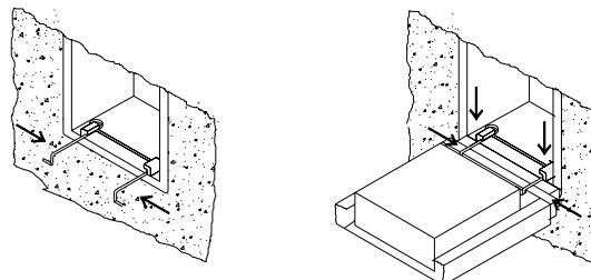
Ensamblaje de la placa en la caja de empotrar a través del muelle bisagra.
