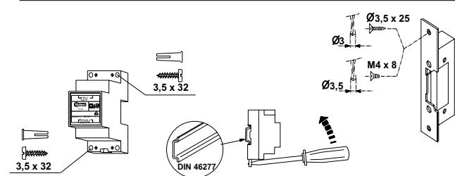
Detalle de la instalación del alimentador y del abrepuertas.
