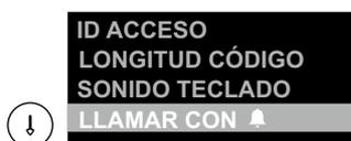
Determina si es necesario pulsar la tecla **Ⓜ** para realizar llamada a los monitores/ teléfonos de la instalación. Para cambiar pulsar **Ⓜ**.
