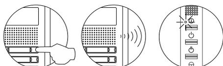
Presionar el pulsador de la placa que se desea que llame a este monitor. En dicho instante, la placa emitirá unos tonos y parpadeará el indicador luminoso del monitor (en color rojo).
