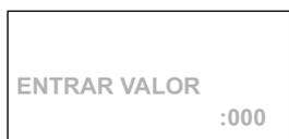
Para cambiar el valor pulsar **(A)**, apareciendo el mensaje ENTRAR VALOR; introducir el código de edificio mediante el teclado numérico y validar pulsando **(A)**. Si pulsa **(C)** se restaurará el valor anterior.
