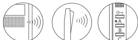
Para indicar que el equipo está listo para la programación, la placa y el auricular del teléfono emitirán unos tonos (el led del teléfono se ilumina fijo en color rojo), pudiendo soltar el pulsador de abrepuertas. Para establecer comunicación de audio con la placa, descolgar el auricular.
