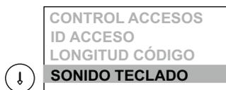
Determina si la placa emite tonos de confirmación al pulsar las teclas. Para cambiar pulsar **Ⓜ**.
