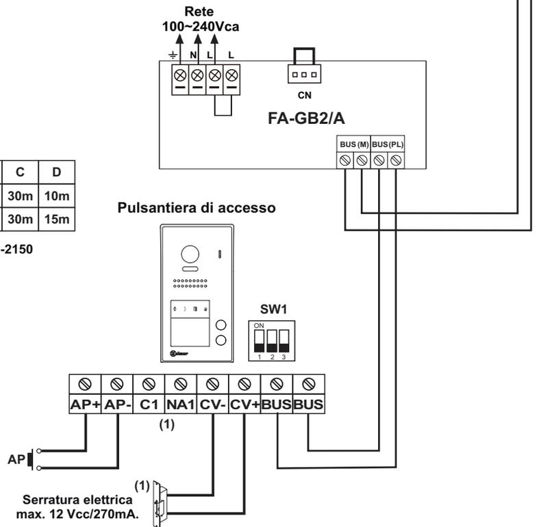
(1) **Importante:** Per serratura elettrica in corrente alternata, una 2° serratura elettrica in corrente alternata o un cancello automatico vedi gli schemi di installazione a pag. 27.
