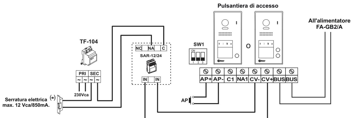
(\*) **Importante:** Collocare il varistore fornito con il kit direttamente sui terminali della serratura elettrica.
