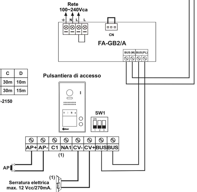
(1) **Importante:** Per serratura elettrica in corrente alternata, una 2° serratura elettrica in corrente alternata o un cancello automatico vedi gli schemi di installazione a pag. 27.
