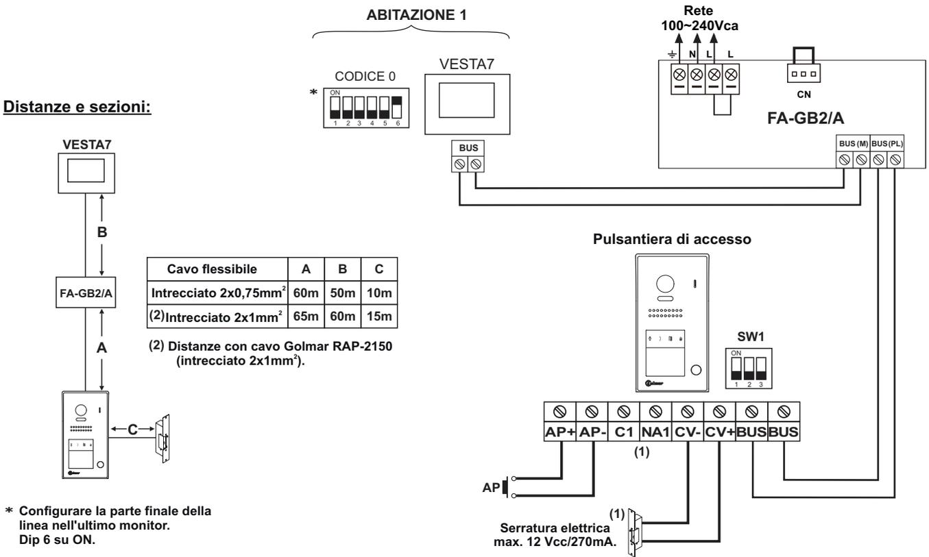
***Installazione di 2 abitazioni con 1 monitor VESTA7 per abitazione e serratura elettrica in corrente continua Golmar.***
