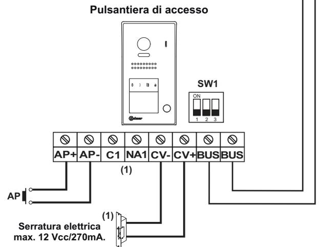
**Installazione di 2 abitazioni con monitor VESTA2 in parallelo (In-Out) e serratura elettrica in corrente continua Golmar.**
