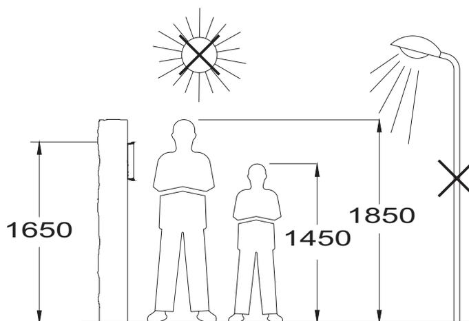
Collocare la parte superiore della pulsantiera a una altezza di 1,65m.
