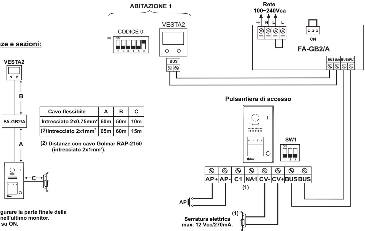
***Installazione di 2 abitazioni con 1 monitor VESTA2 per abitazione e serratura elettrica in corrente continua Golmar.***
