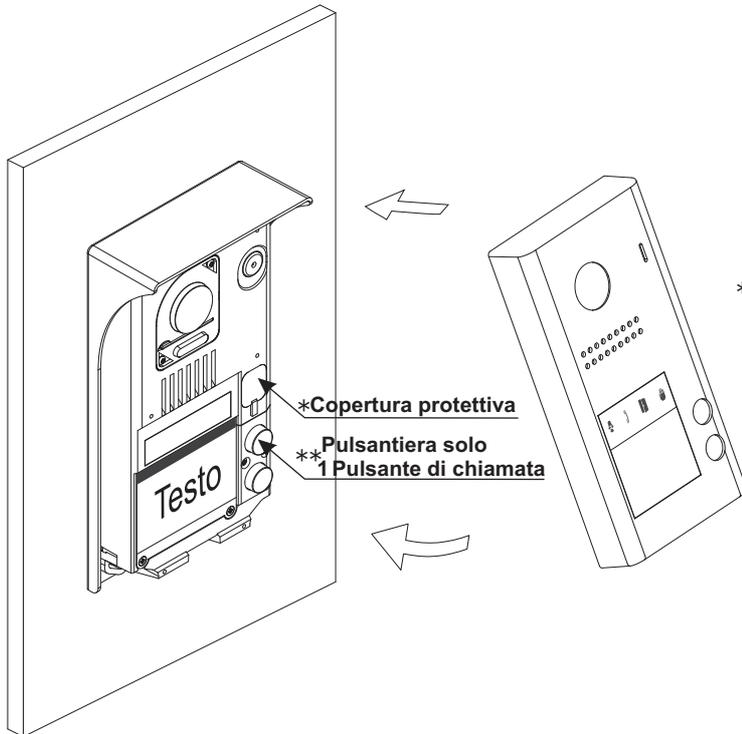
Per terminare il montaggio della pulsantiera, riposizionare il frontale in metallo.
