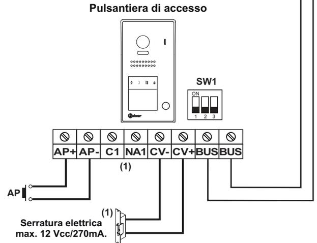
**Installazione di 2 abitazioni con monitor VESTA7 in parallelo (In-Out) e serratura elettrica in corrente continua Golmar.**
