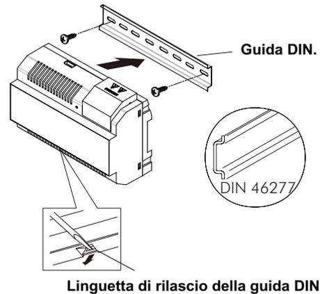
L'alimentatore può essere installato su una guida DIN 46277. Per rimuovere l'alimentatore dalla guida utilizzare un cacciavite a punta piatta e fare leva come mostra la figura. Il modello FA-GB2/A richiede 8 elementi nella guida.
