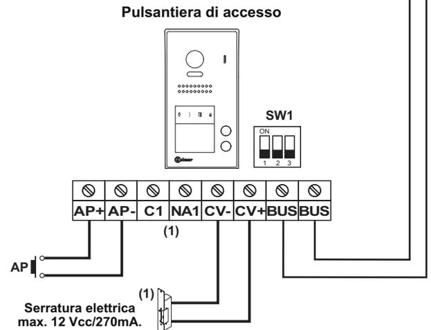
(1) **Importante:** Per serratura elettrica in corrente alternata, una 2° serratura elettrica in corrente alternata o un cancello automatico vedi gli schemi di installazione a pag. 27.
