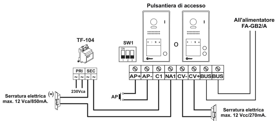
(\*) **Importante:** Collocare il varistore fornito con il kit direttamente sui terminali della serratura elettrica.
