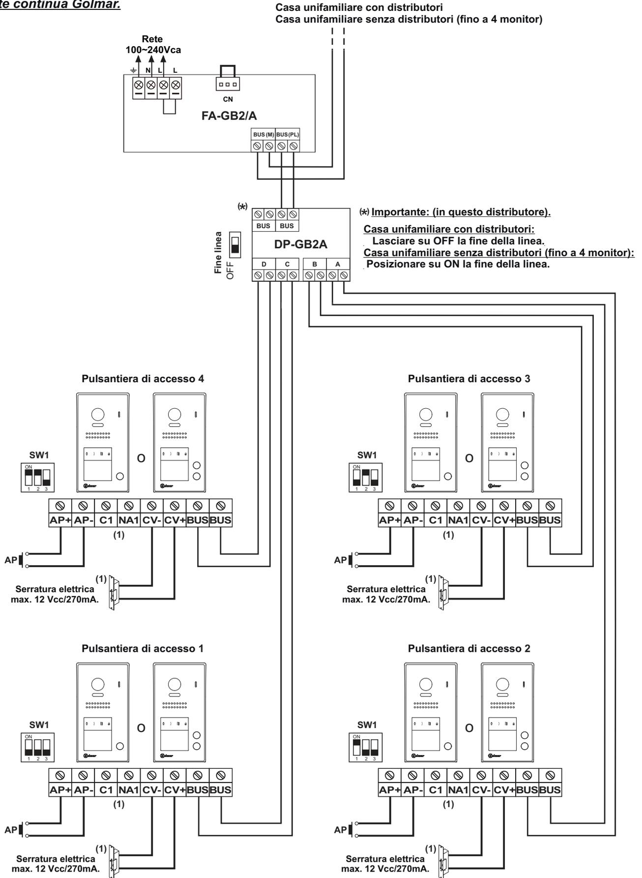
(1) **Importante:** Per serratura elettrica in corrente alternata, una 2° serratura elettrica in corrente alternata o un cancello automatico vedi gli schemi di installazione a pag. 27.
