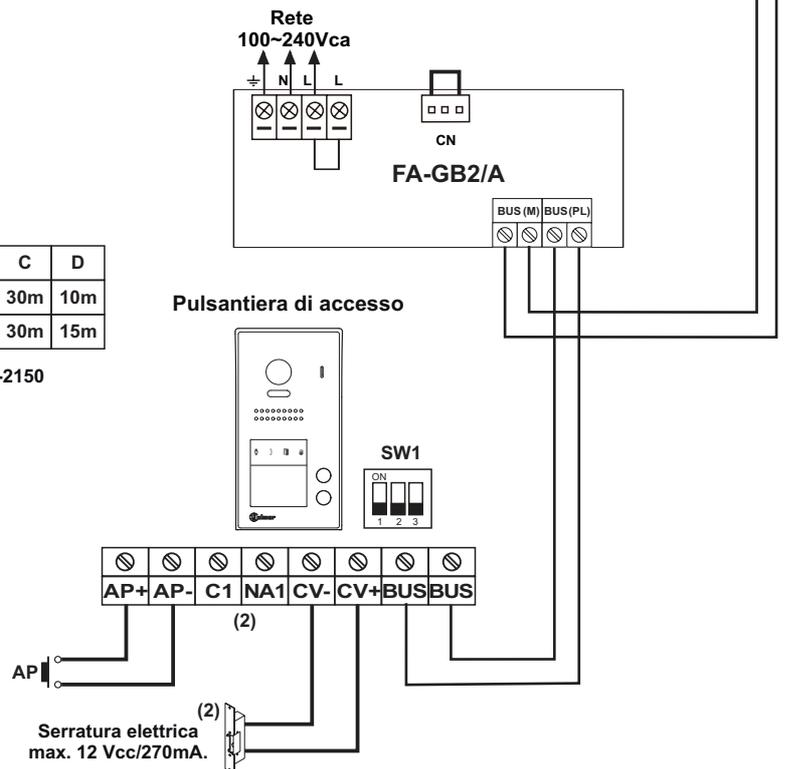
(2) **Importante:** Per serratura elettrica in corrente alternata, una 2° serratura elettrica in corrente alternata o un cancello automatico vedi gli schemi di installazione a pag. 27.
