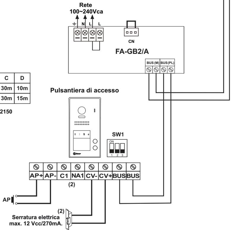
(2) **Importante:** Per serratura elettrica in corrente alternata, una 2° serratura elettrica in corrente alternata o un cancello automatico vedi gli schemi di installazione a pag. 27.
