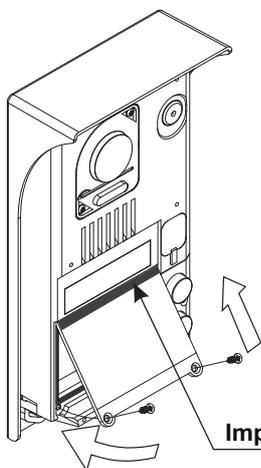
Una volta terminato il cablaggio e la configurazione, posizionare il portatarghetta nel modulo elettronico. Fissare con le viti fornite.
