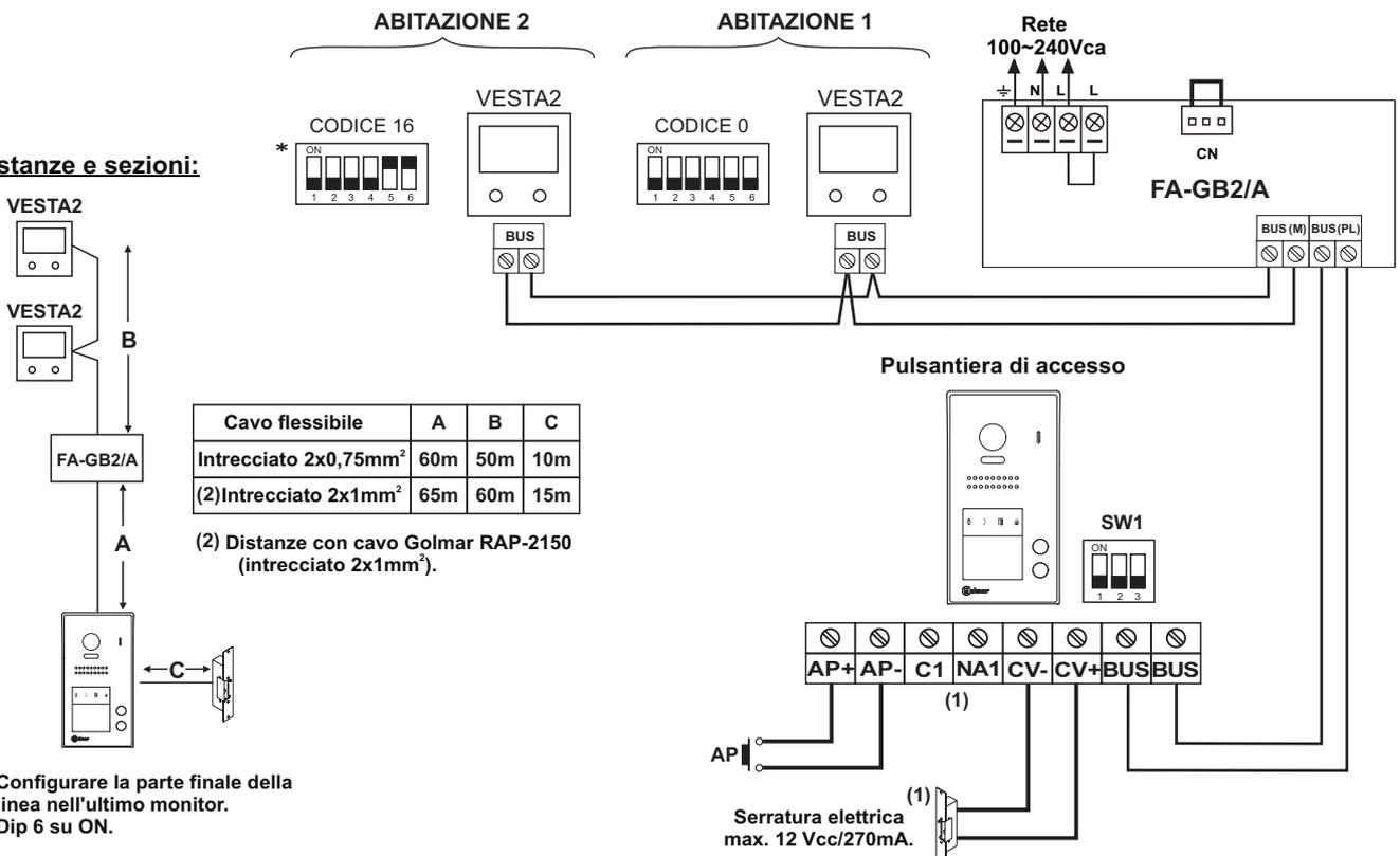
(1) **Importante:** Per serratura elettrica in corrente alternata, una 2° serratura elettrica in corrente alternata o un cancello automatico vedi gli schemi di installazione a pag. 27.
