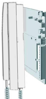
Si se desea sacar el monitor una vez instalado, realizar presión mediante un destornillador plano sobre la pestaña de fijación de la regleta. Una vez liberado el monitor, abrirlo en forma de libro y separarlo de la regleta, con cuidado de que no caiga.
