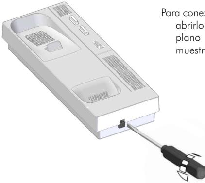
Para conectar el teléfono y fijarlo a la pared, es necesario abrirlo. Realizar levemente palanca con un destornillador plano en las ranuras dispuestas para ello, tal y como muestra el dibujo.
