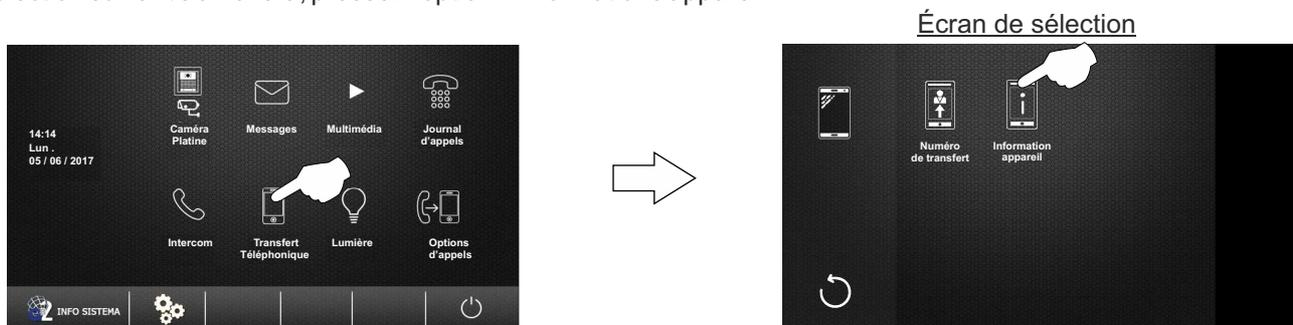
L'écran d'information du dispositif suivant s'affichera, en indiquant l'état du module GSM GB2. Pressez l'option
