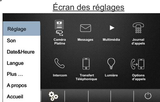
**9.1.4 Pour accéder aux réglages de renommage de platine / caméra, délai d'auto-allumage et de désactivation d'intercom**, pressez l'option « Plus... ». L'écran de réglages suivant s'affichera.
