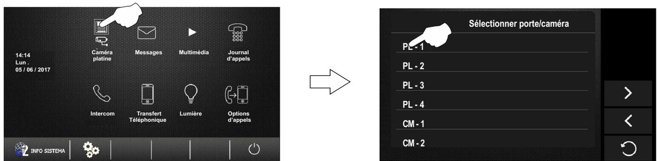
L'écran suivant apparaîtra et affichera l'image de la plaque ayant l'adresse 1, en indiquant la plaque sélectionnée « PL - 1 » et le temps écoulé de connexion. La connexion prend fin après 30 secondes ou en pressant sur l'option ↻.
