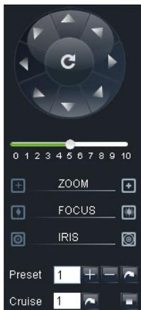
Control del sentido de movimiento PTZ: permite controlar el sentido de la cámara PTZ. El botón central se llama [Auto-cruise] (Navegación automática).
