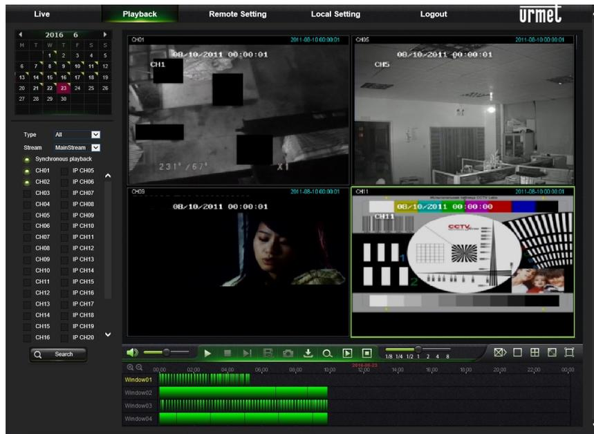
Marcando la opción  Synchronous playback, el canal seleccionado se reproduce de manera sincrónica; como alternativa, es posible controlar la reproducción separada de los canales.
