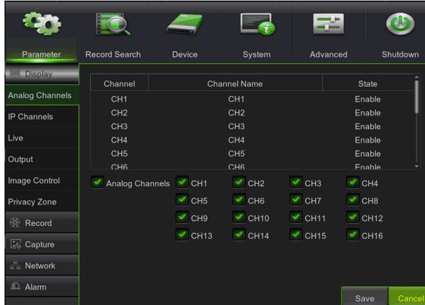
En la parte central se puede ver la lista de los canales analógicos disponibles con el estado correspondiente: Enable (Habilitado), Disable (Excluido). Para cambiar el estado de un solo canal, seleccionar la casilla correspondiente; para ejecutar la operación en todos los canales disponibles, hacer clic en la casilla "Analog Channels (Canales analógicos)". Pulsar el botón "Save" (Guardar) para activar las modificaciones realizadas.
