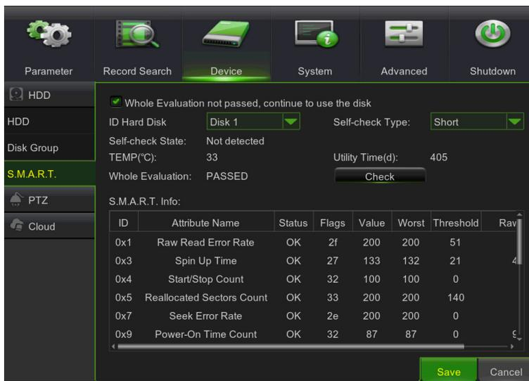
El sistema **Self-Monitoring, Analysis, and Reporting Technology, o S.M.A.R.T.** es un sistema de control de discos duros y SSD, para detectar y proporcionar distintos indicadores de fiabilidad, con el fin de anticipar posibles problemas de funcionamiento.
