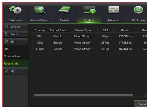
El usuario puede ver la información de las distintas IPC conectadas (Record state, Stream type, Bit Rate, Frame Rate, Resolution etc.) (Estado de grabación, Tipo de frecuencia, Velocidad de bits, Velocidad de fotografías, Resolución, etc.).
