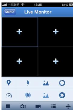
Para gestionar la cámara es necesario ampliar la ventana de la cámara y habilitar el modo PTZ. Seleccionar las flechas junto a la ventana de la cámara para moverla hacia los lados, hacia arriba o hacia abajo. Los otros botones permiten actuar sobre el zoom, forzar, operar sobre el diafragma, sobre la velocidad del PTZ, la preselección, etc., como se muestra en las siguientes figuras.
