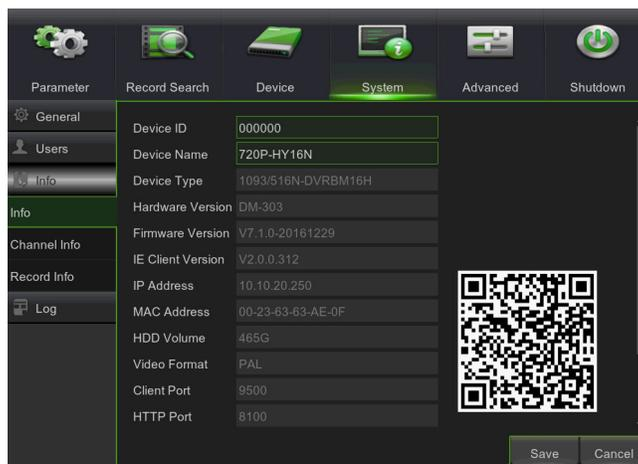
El primer grupo visualizado contiene la siguiente información: Device name (Nombre del Dispositivo), Device ID (ID del Dispositivo), Device type (Tipo de Dispositivo), Device S/N (Número de serie del dispositivo), MAC address (Dirección MAC), IE Client version (Versión Cliente IE), Hardware version (Versión hardware), Firmware Version (Versión firmware), etc.
