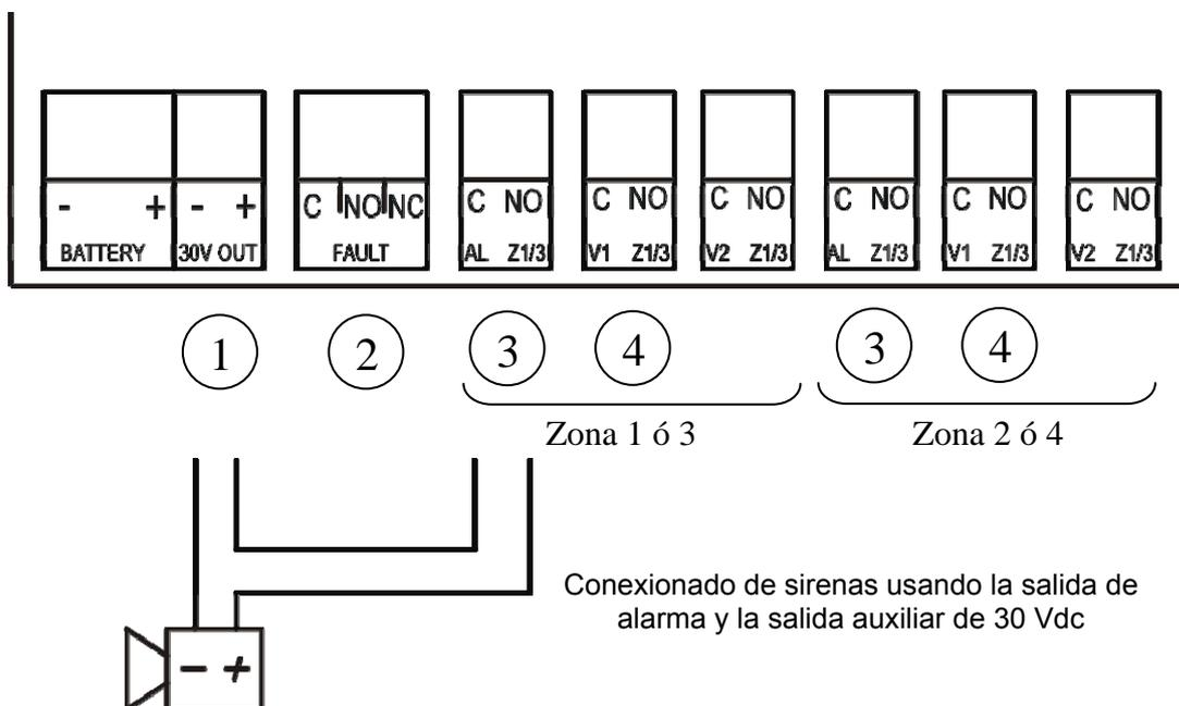
Figura 7: Salidas de la tarjeta de fuente
