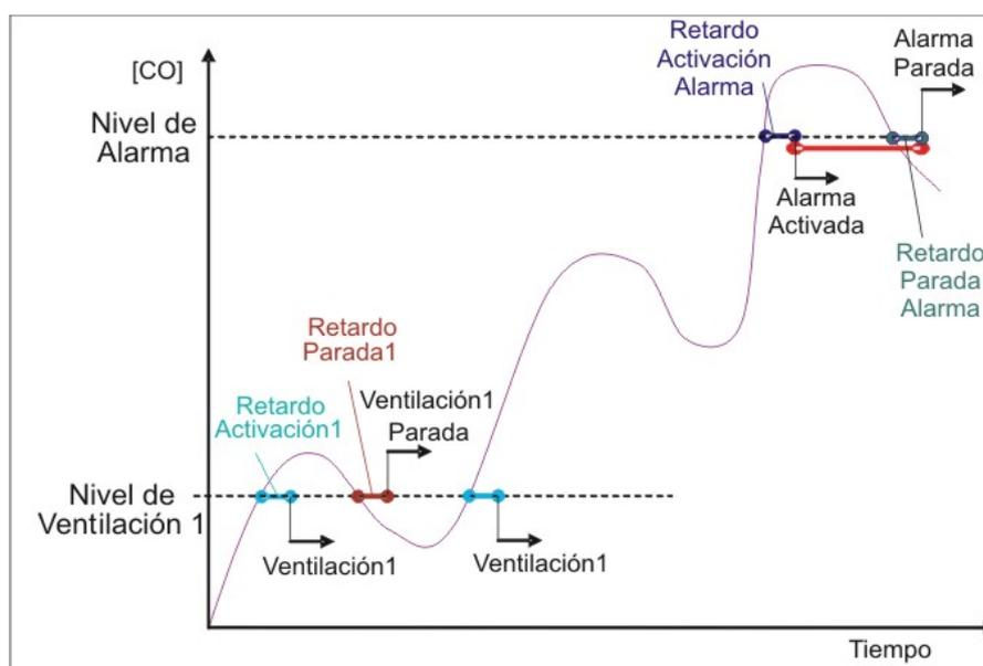
Figura 2: Esquema de funcionamiento de centrales DVB
