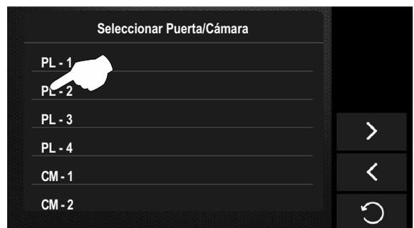
Se mostrará la siguiente pantalla con la imagen procedente de la placa con dirección 2, indicando la placa seleccionada "PL-2" y el tiempo transcurrido de conexión. La conexión tendrá una duración de 30 segundos o hasta pulsar la opción .
