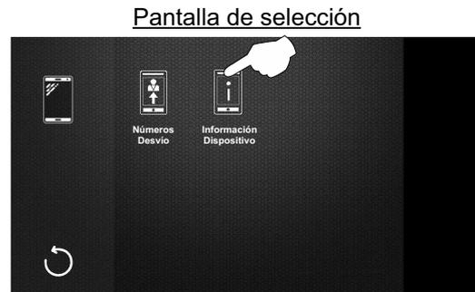
A continuación se mostrará la pantalla de información dispositivo, indicando el estado del módulo GSM GB2. Pulse la opción
