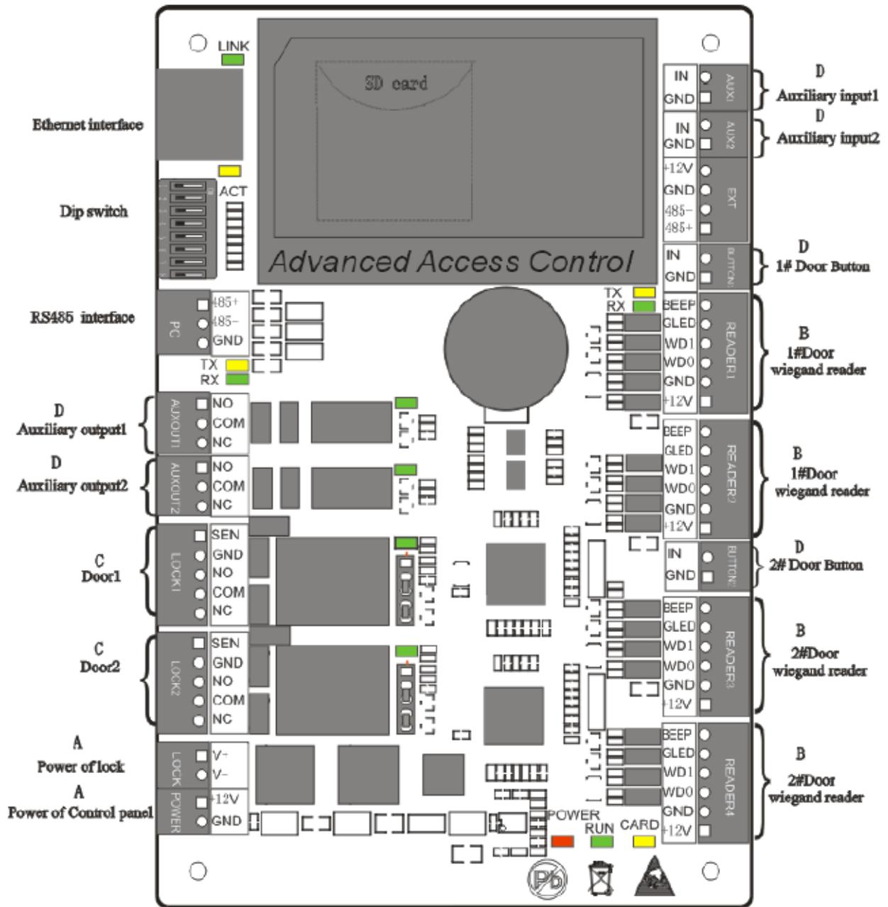
Diagrama de conexiones del terminal C3400
