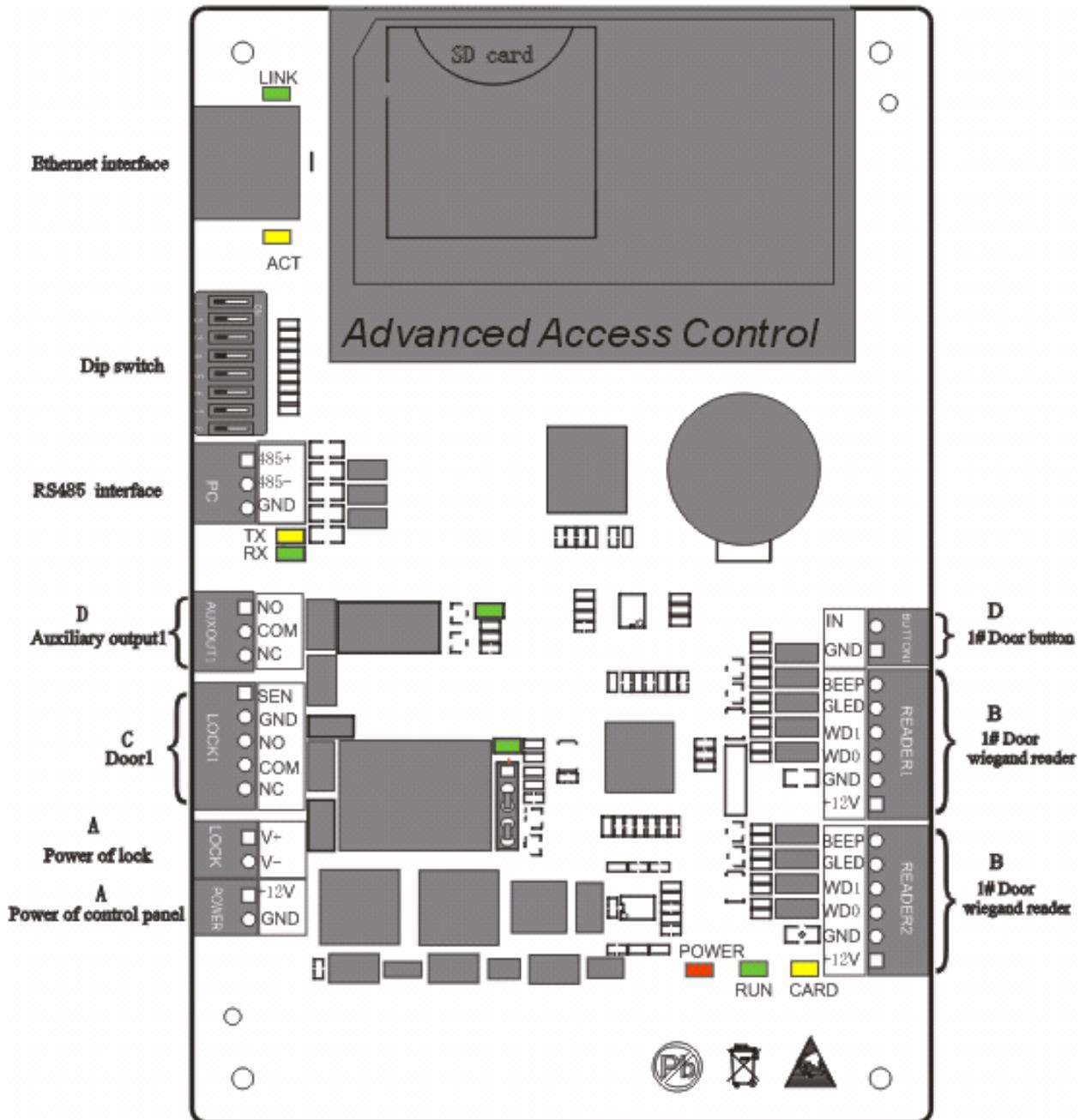
Diagrama de conexiones del terminal C3200
