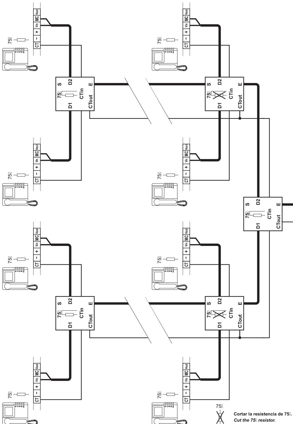
**1** Un montante con conexión en cascada.
