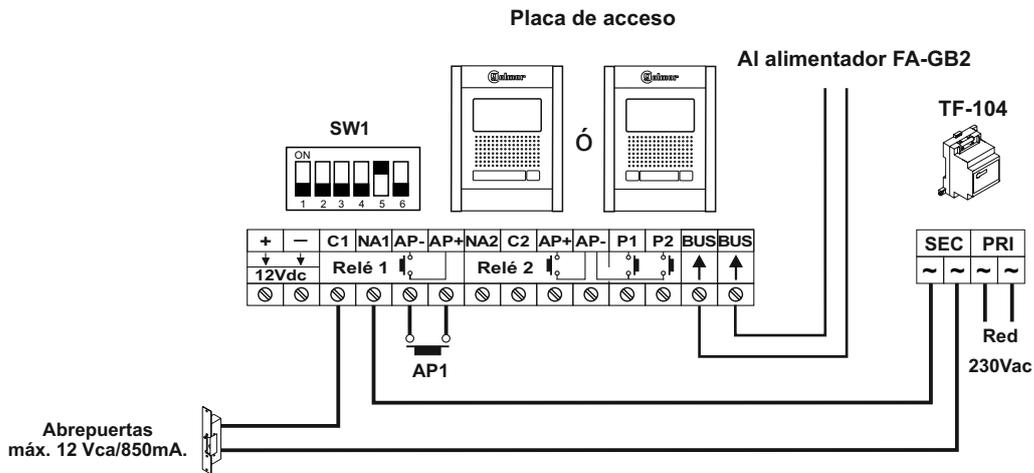
Conexión de 2 abrepuertas de alterna con "AP":
