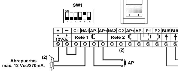
(2) **Importante:** Para abrepuertas de alterna o un 2º Abrepuertas ver esquema "conexión de abrepuertas de continua y alterna" pág. 19.
