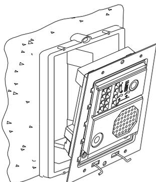
El bastidor puede ahora abatirse horizontalmente facilitando de esta manera realizar tanto el conexionado como ajustes en el módulo de sonido.
