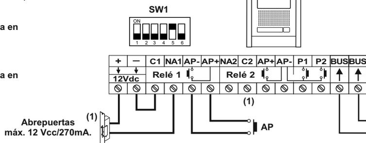
(1) **Importante:** Para abrepuertas de alterna o un 2º Abrepuertas ver esquema "conexión de abrepuertas de continua y alterna" pág. 19.
