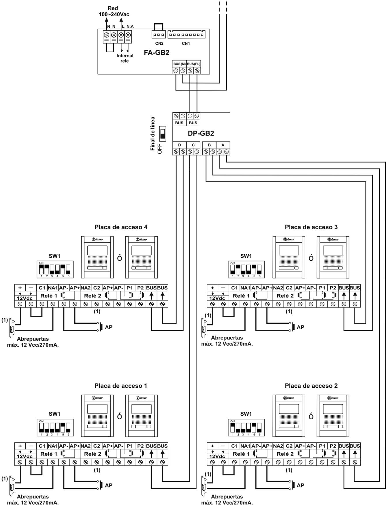
(1) **Importante:** Para abrepuertas de alterna o un 2º Abrepuertas ver esquema "conexión de abrepuertas de continua y alterna" pág. 19.
