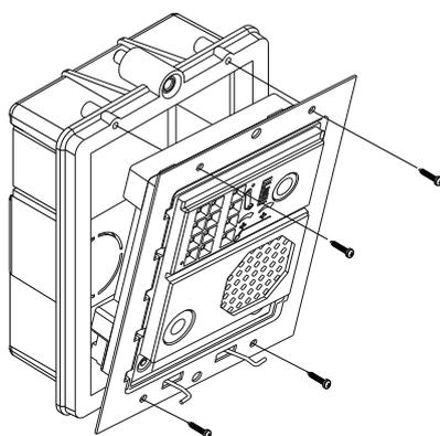
Una vez terminados los trabajos de cableado, configuración y ajustes, fijar el bastidor en la caja de empotrar mediante los tornillos suministrados.
