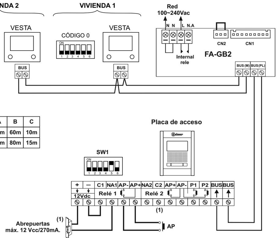
(1) **Importante:** Para abrepuertas de alterna o un 2º Abrepuertas ver esquema "conexión de abrepuertas de continua y alterna" pág. 19.
