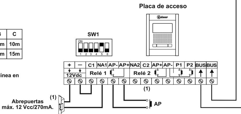
(1) Importante: Para abrepuertas de alterna o un 2º Abrepuertas ver esquema "conexión de abrepuertas de continua y alterna" pág. 19.
