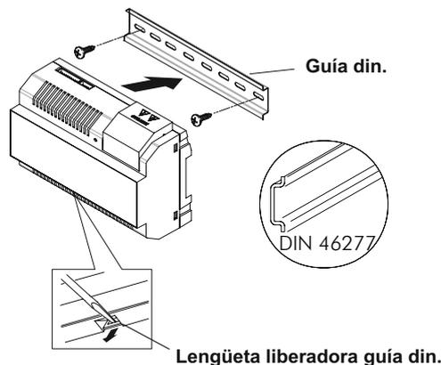
El alimentador puede instalarse en guía DIN 46277.
