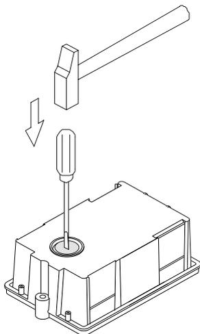
Romper el tabique para la entrada de cables por la parte inferior de la caja.
