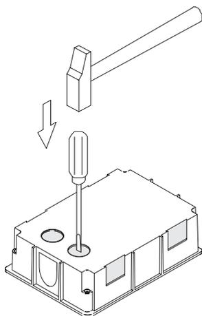
Romper el tabique para la entrada de cables por la parte inferior de la caja.
