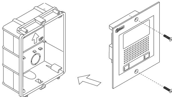
Una vez terminados los trabajos de cableado, configuración y ajustes, fijar la placa a la caja de empotrar mediante los tornillos antivandálicos suministrados, utilizando la punta para mango de 1/4" antivandálica suministrada.
