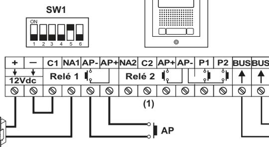
\* Configurar final de línea en el último distribuidor. Interruptor a On.
