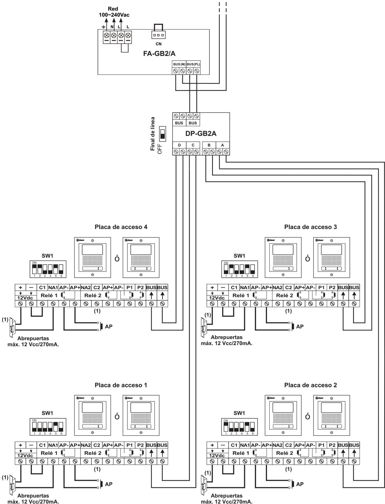
(1) **Importante:** Para abrepuertas de alterna o un 2º Abrepuertas ver esquema "conexión de abrepuertas de continua y alterna" pág. 18.
