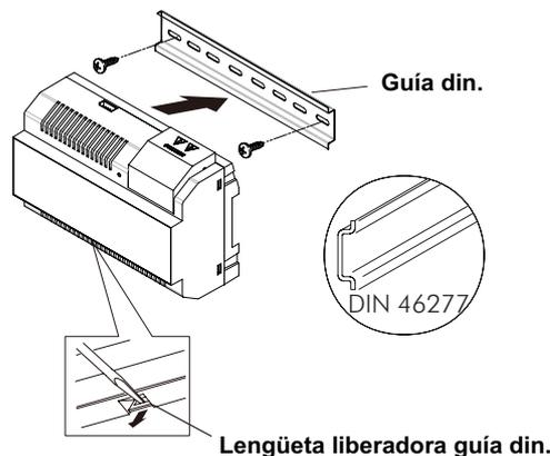
El alimentador puede instalarse en guía DIN 46277. Para sacar el alimentador de la guía utilizar un destornillador plano y hacer palanca tal y como muestra el dibujo. El modelo FA-GB2/A precisa de 8 elementos en la guía.
