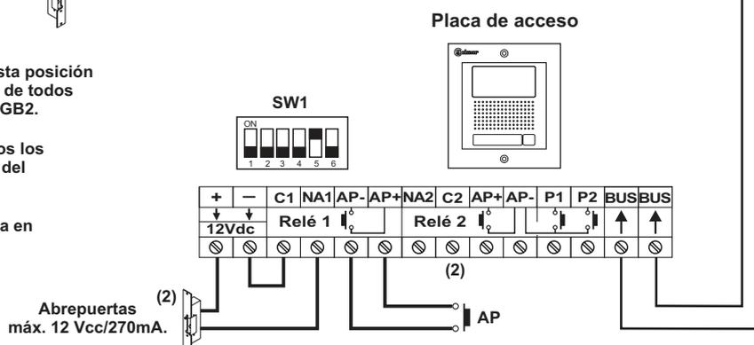
(2) **Importante:** Para abrepuertas de alterna o un 2º Abrepuertas ver esquema "conexión de abrepuertas de continua y alterna" pág. 18.
