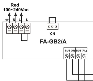
(1) Colocar el puente en esta posición para monitores 7" GB2 de todos los distribuidores D2L-GB2.
