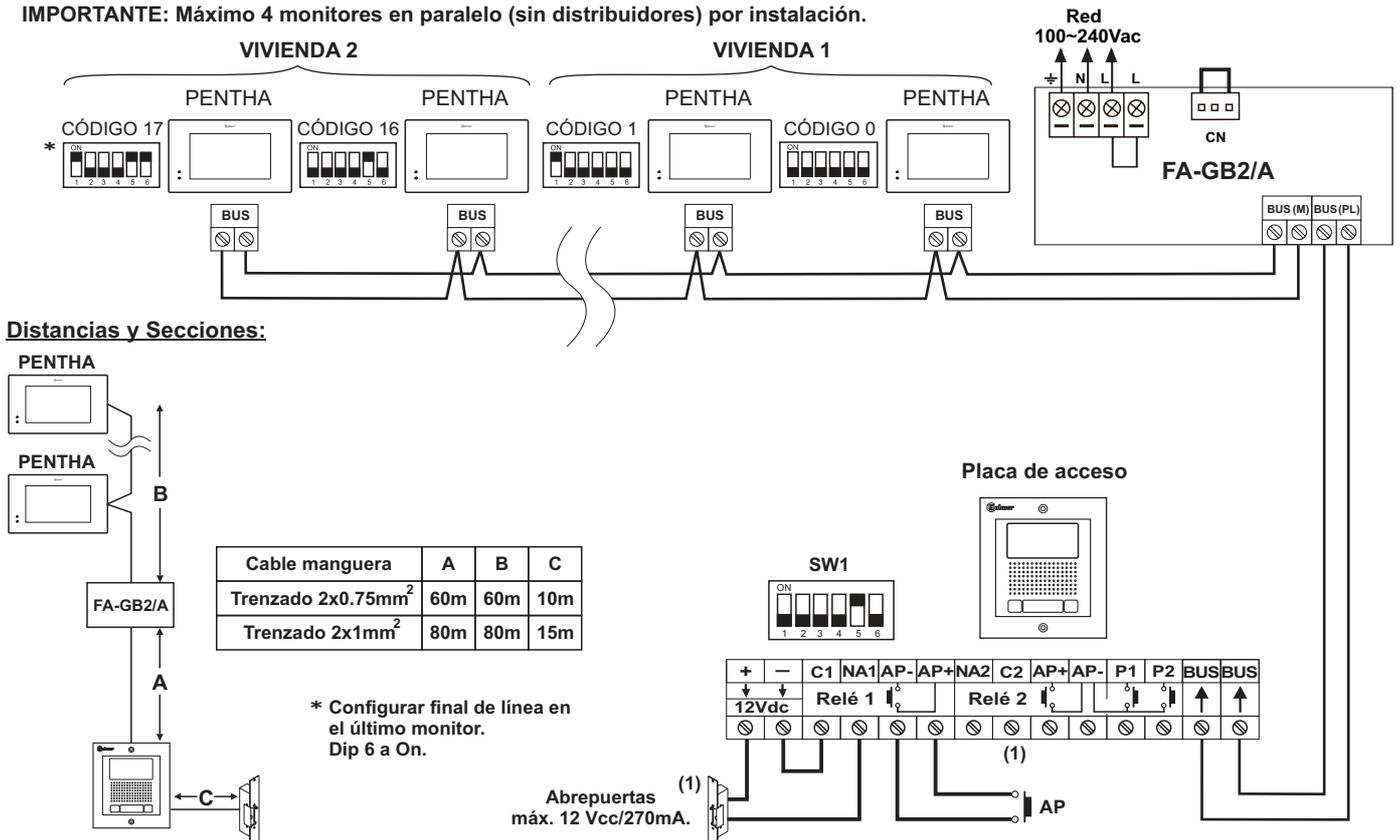
(1) Importante: Para abrepuertas de alterna o un 2º Abrepuertas ver esquema "conexión de abrepuertas de continua y alterna" pág. 18.
