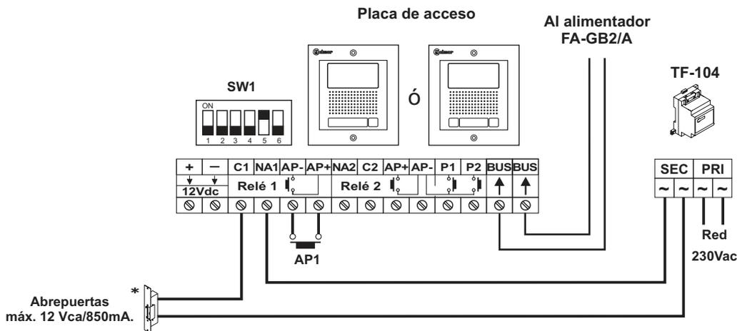
\* **Importante:** Coloque el varistor suministrado con el kit directamente sobre los terminales del abrepuertas.
