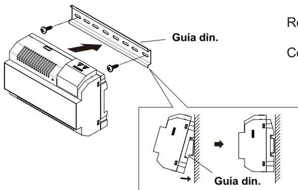
Recuerde que la normativa vigente obliga a proteger el alimentador con un interruptor magnetotérmico. Conecte el alimentador FA-GB2/A a una toma de tierra.
