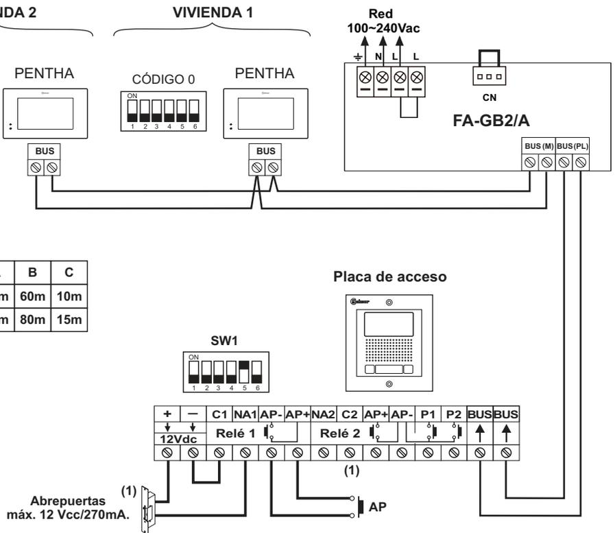
(1) **Importante:** Para abrepuertas de alterna o un 2º Abrepuertas ver esquema "conexión de abrepuertas de continua y alterna" pág. 18.
