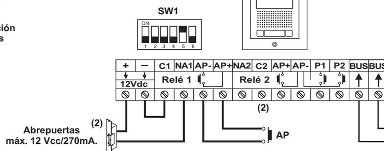
(2) **Importante:** Para abrepuertas de alterna o un 2º Abrepuertas ver esquema "conexión de abrepuertas de continua y alterna" pág. 18.
