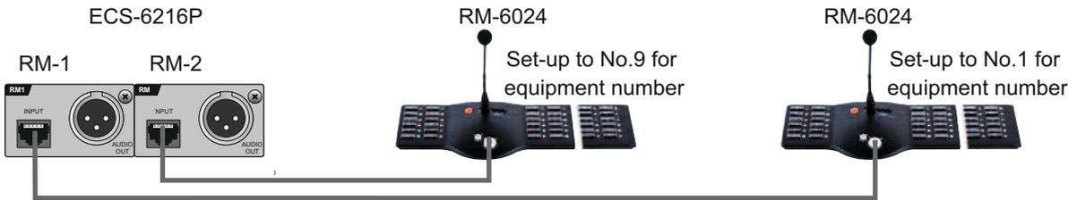
3) Al conectar micrófonos remotos a través de un RME-6108 a un ECS-6216P:
