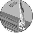
Brancher le câble de connexion des poussoirs au connecteur CN6 du circuit microprocesseur EL500SE. Ce câble dispose de 10 fils conducteurs (P1 à P8, B et CP) pour la connexion de poussoirs ou modules d'extension EL516SE. Voir manuel T500SE ML pour détails de connexion de poussoirs d'appel.
