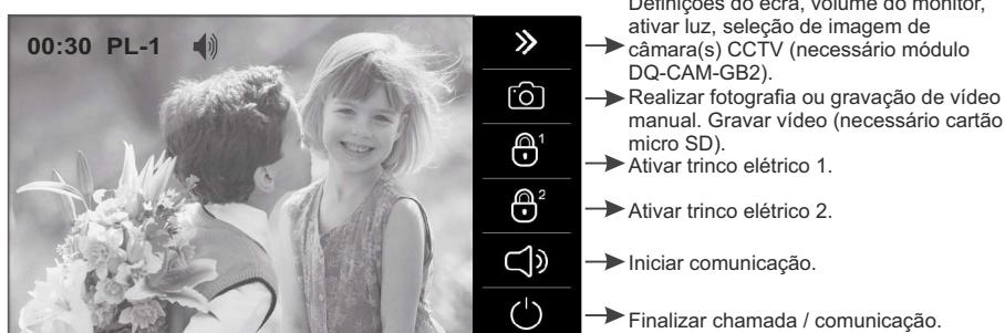
1 Se quiser abrir a porta 1, carregue na opção de abertura de porta no ecrã durante o processo de chamada ou em comunicação: uma premência ativa o trinco elétrico durante 5 segundos.
