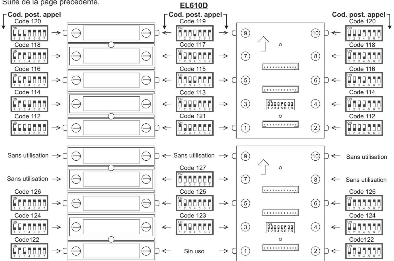
**IMPORTANT** : pour le poste d'appel T562/ TNHEA , le Dip 10 du micro-interrupteur de configuration doit se trouver sur ON.
