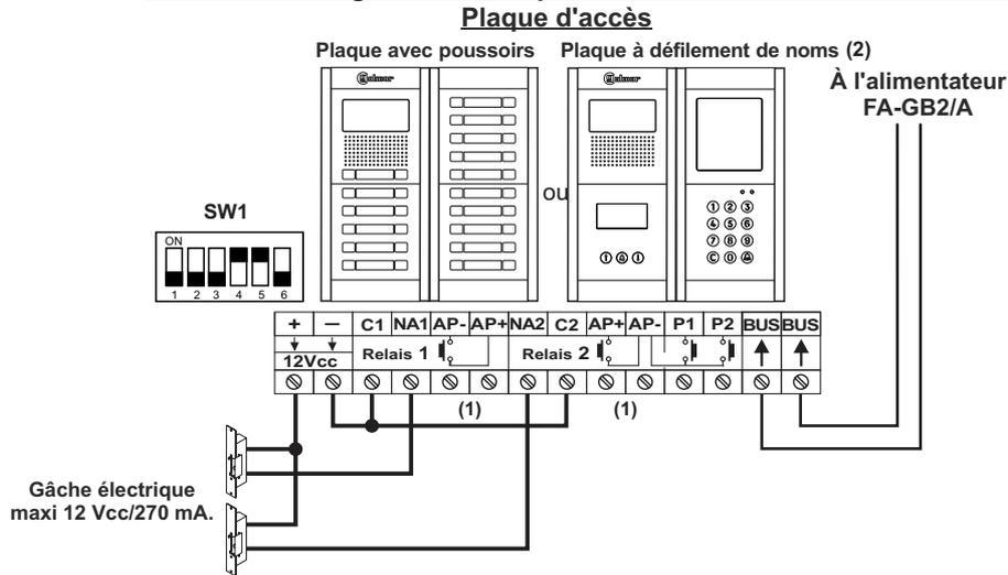
(1) Important : Avec 2 gâches électriques de courant continue, il est impossible d'utiliser les poussoirs d'ouverture de porte « AP ».
