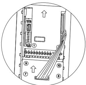
Connecter le câble de connexion de courte distance, fourni avec le produit EL610D, au connecteur du groupe phonique et l'autre extrémité du câble au connecteur situé sur la partie supérieure du module poussoirs EL610D, comme l'illustre le schéma.
