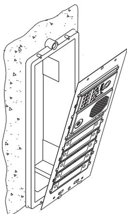
Le bâti peut maintenant être rabattu horizontalement afin de faciliter les travaux de branchement et les réglages du groupe phonique et du module poussoirs.
