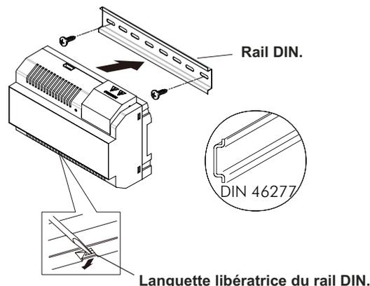
L'alimentateur peut-être installé sur guide DIN 46277. Pour retirer l'alimentateur du guide, utiliser un tournevis plat et effectuer un mouvement de levier comme indiqué sur le schéma ci-joint.
