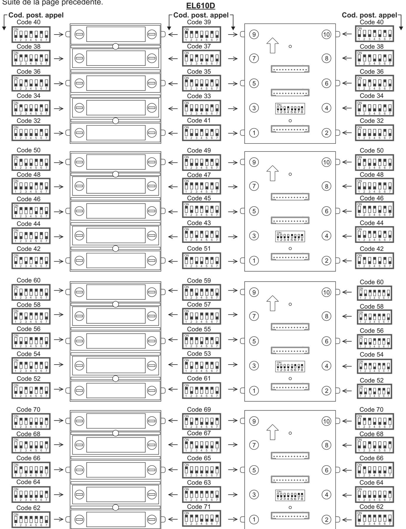
**IMPORTANT** : pour le poste d'appel T562/ TNHEA , le Dip 10 du micro-interrupteur de configuration doit se trouver sur ON.
