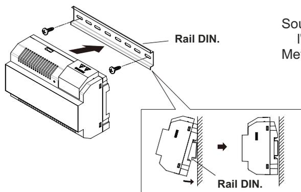
Souvenez-vous que la régulation en vigueur oblige à protéger l'alimentateur par un interrupteur magnétothermique. Mettez l'alimentateur FA-GB2/A à la terre.
