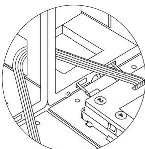
Entre les modules poussoirs EL610D de différents boîtiers d'encastrement, brancher le câble de connexion de courte distance au connecteur inférieur du dernier module EL610D du premier boîtier d'encastrement et l'autre extrémité au connecteur du dernier module poussoirs EL610D situé sur la partie inférieure du deuxième boîtier d'encastrement, comme l'illustre le schéma.
