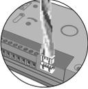
Conectar el cable de conexión de pulsadores en el conector CN4 del módulo de sonido EL520, dicho cable dispone de 10 conductores (P1 a P8, B y CP) para la conexión de pulsadores o circuitos decodificadores EL516SE. Ver manual T2PlusML para detalles de conexión de los pulsadores.
