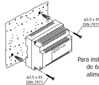
Instale el alimentador en un lugar seco y protegido. Recuerde que la normativa vigente obliga a proteger el alimentador con un interruptor magnetotérmico y a conectarlo a una toma de tierra.
