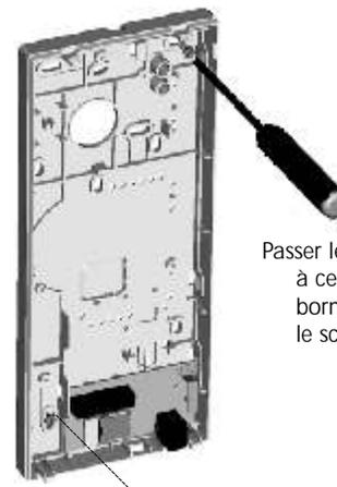
Passer les câbles par le trou prévu à cet effet et connecter les aux borniers de raccordement en suivant le schéma de branchement.
