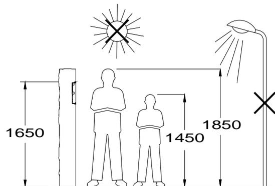
Percer un trou dans le support où l'on souhaite installer la plaque de rue, à une hauteur de 1,65m. Les dimensions du trou sont:
