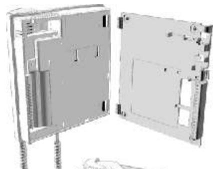
Placer le moniteur perpendiculairement à l'étrier et aligner les trous de fixation du moniteur avec les crochets de l'étrier de connexion, comme indiqué sur le dessin.
