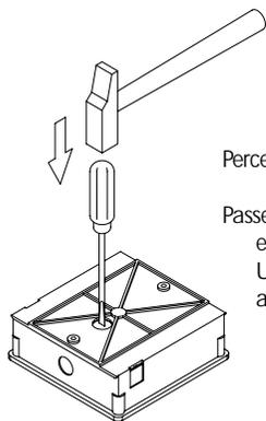
Percer le fond du boîtier pour le passage des câbles.
