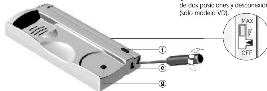
Abrir el teléfono para instalarlo: introducir un destornillador plano en las ranuras de apertura y realizar palanca tal y como muestra el dibujo.
