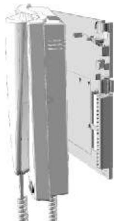
Fermer le moniteur comme un livre, en exerçant une légère pression sur la partie droite du moniteur jusqu'au 'clac' de fermeture.
