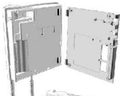
Colocar el monitor perpendicular a la regleta, haciendo coincidir los agujeros de la base del monitor con las pestañas de sujeción de la regleta, tal y como muestra el dibujo.
