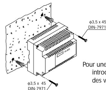
Installer l'alimentation dans un endroit sec et protégé. Son alimentation devra être protégée en tête de ligne par un disjoncteur/interrupteur différentiel 30mA et comporter une mise à la terre.
