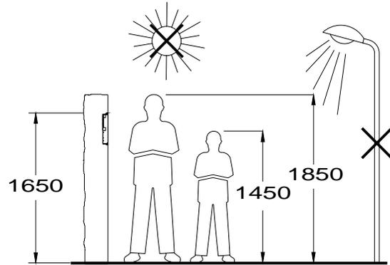
Realizar un agujero en la pared que ubique la parte superior de la placa a una altura de 1,65m. Las dimensiones del agujero son: 131(An) x 131(AI) x 45(P) mm.
