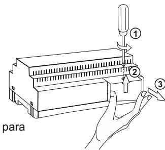
Terminados los trabajos de instalación y cableado, coloque la tapa de protección antes de reponer la corriente eléctrica.
