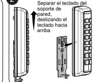
Fiiar el soporte de montaje a la paréd usando los tornillos suministrados
