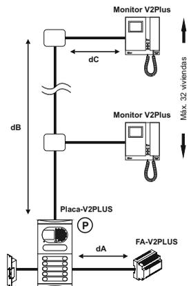
**IMPORTANTE:** La distancia a incrementar con el **repetidor**, dependerá de la sección del cable instalado.
