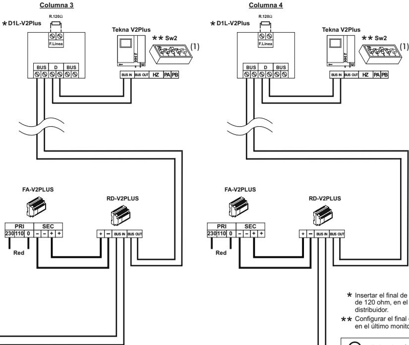
\* Insertar el final de línea de 120 ohm, en el último distribuidor.
