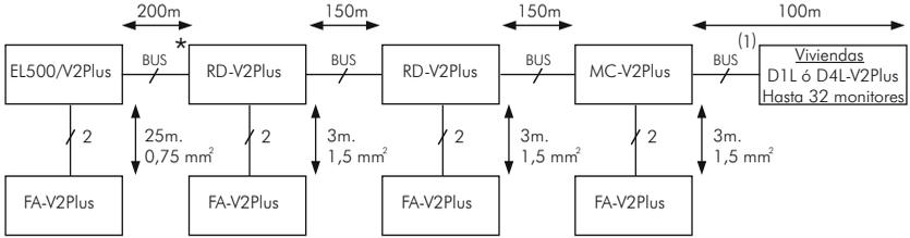
**F: Repetidor en cascada (32 elementos por columna / 600 metros):**
