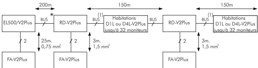
(1) **Important:** Ne pas dépasser le nombre max. de moniteurs/postes d'appel connectés à une plaque/multiplexeur/répéteur, ou les distances indiquées pour plaque/multiplexeur/répéteur et le dernier moniteur et entre les moniteurs de différents habitations connectés à la plaque/multiplexeur/répéteur. Pour les caractéristiques, sections et distances voir le manuel de produit correspondant.
