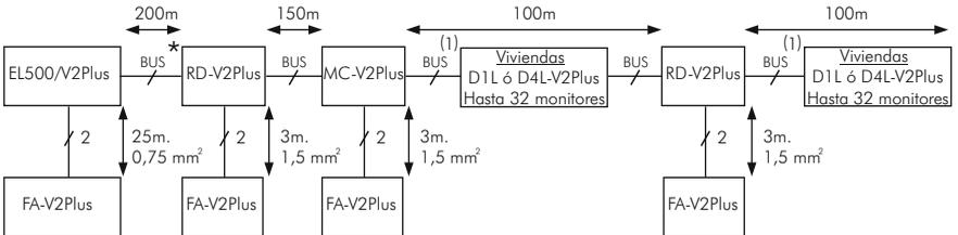
(1) **Importante:** No superar el n° máx. de monitores/teléfonos conectados a una placa/multiplexor/repetidor, ni las distancias indicadas para placa/multiplexor/repetidor y último monitor y entre monitores de las distintas viviendas conectadas a la placa/multiplexor/repetidor. Ver características, secciones y distancias en el manual del producto correspondiente.
