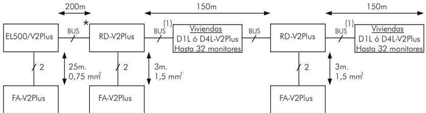
(1) **Importante:** No superar el n° máx. de monitores/teléfonos conectados a una placa/multiplexor/repetidor, ni las distancias indicadas para placa/multiplexor/repetidor y último monitor y entre monitores de las distintas viviendas conectados a la placa/multiplexor/repetidor. Ver características, secciones y distancias en el manual del producto correspondiente.
