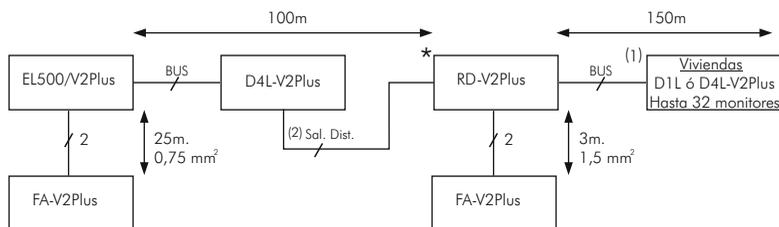
(2) Hasta 1 RD-V2Plus por cada salida distribuida del D1L ó D4L-V2Plus.
