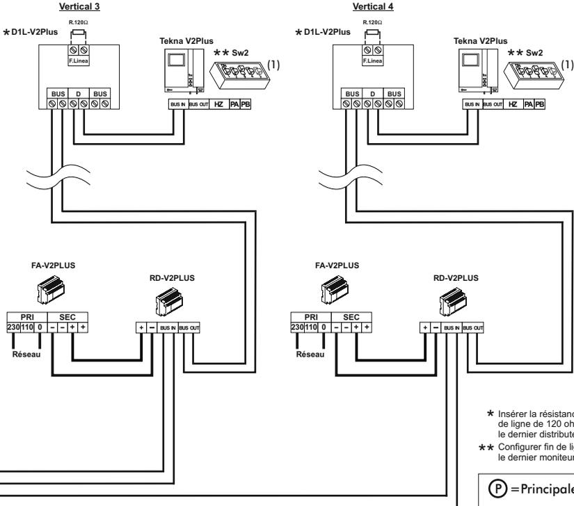
★ Insérer la résistance de fin de ligne de 120 ohm, dans le dernier distributeur.
