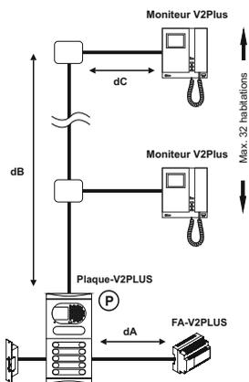
**IMPORTANT:** La distance à augmenter par le **répéteur** dépendra de la section du câble installé.
