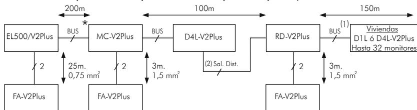
(2) Hasta 1 RD-V2Plus por cada salida distribuida del D1L ó D4L-V2Plus.
