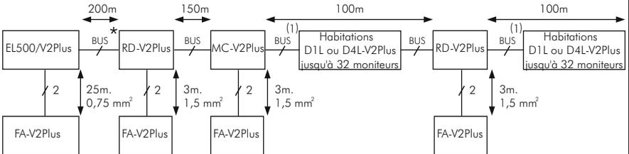
(1) **Important:** Ne pas dépasser le nombre max. de moniteurs/postes d'appel connectés à une plaque/multiplexeur/répéteur, ou les distances indiquées pour plaque/multiplexeur/répéteur et le dernier moniteur et entre les moniteurs de différents habitations connectés à la plaque/multiplexeur/répéteur. Pour les caractéristiques, sections et distances voir le manuel de produit correspondant.
