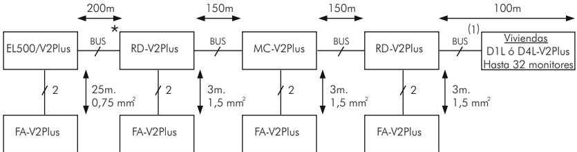
**G: Repetidor en cascada (64 elementos por columna / 550 metros):**
