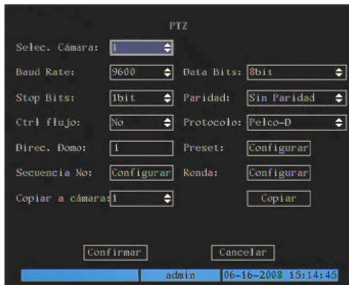
Figura 35: menú de configuración de los parámetros PTZ
