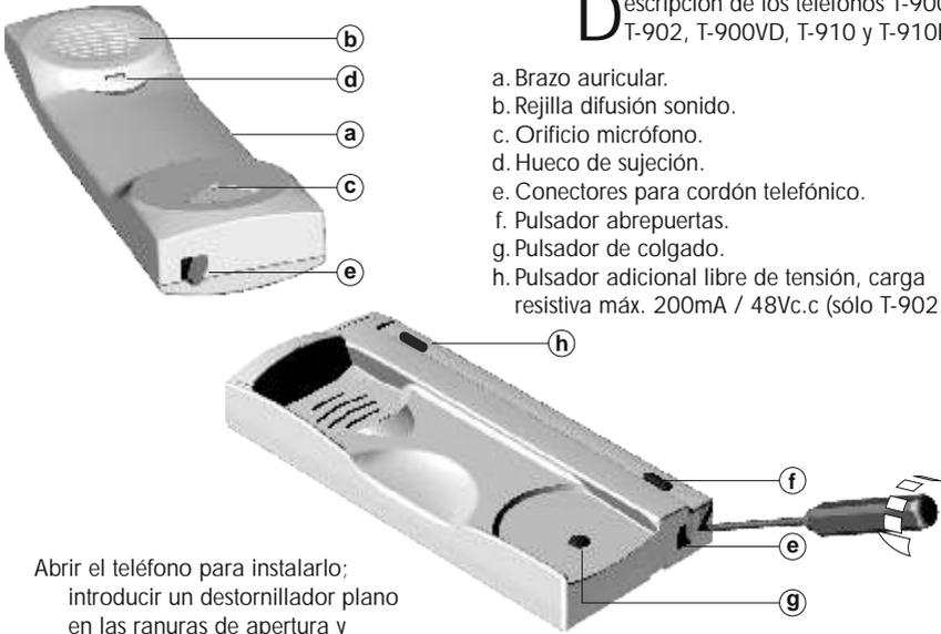
Abrir el teléfono para instalarlo; introducir un destornillador plano en las ranuras de apertura y realizar palanca tal y como muestra el dibujo.
